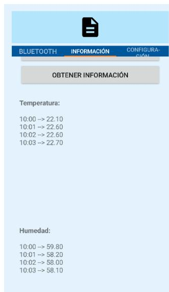
Ilustración 46 - Captura de verificación para la extracción de datos de la microSD.
