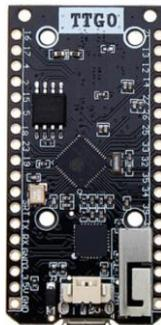
*Ilustración 18 - Dispositivo TTGO EPS32 (parte frontal).*
