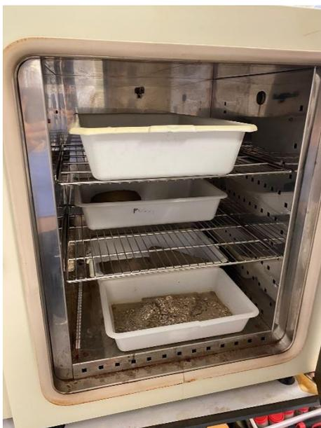
Figura 3-7. Muestras de sedimento secándose en la estufa.
