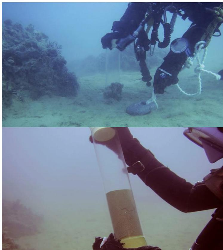
Figura 3-3. Obtención de una de las muestras de sedimento.
