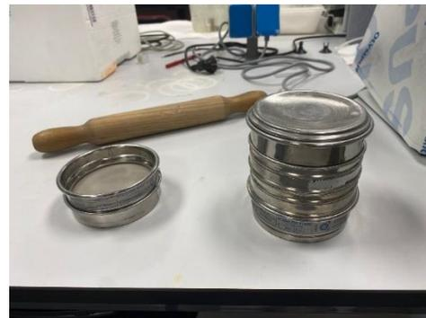
Figura 3-6. Tamices usados para el estudio granulométrico.
