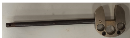
Figura 3.6 Péndulo de 1 J para equipo de ensayo de impacto Charpy.
