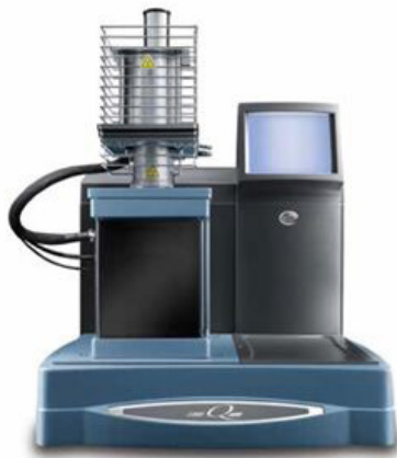
Figura 3.10 Equipo TMA. Fuente: referencia [70].
