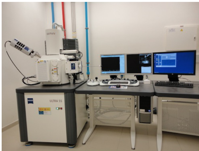
Figura 3.12 Equipo FESEM. Fuente: referencia [72].
