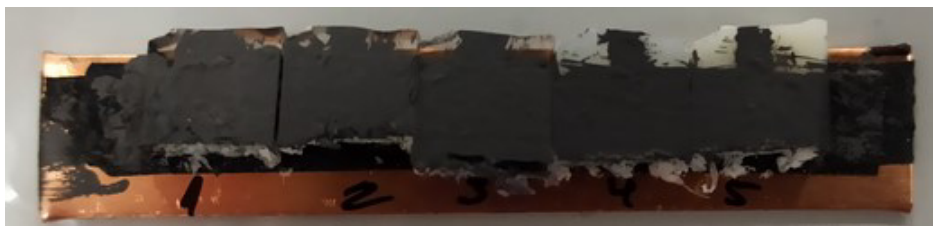
Figura 3.13 Probeta para la realización de FESEM. 1: PLA, 2: PLA/20DIPT, 3: PLA/20DMT, 4: PLA/20TOAC, 5: PLA/20TOSU.
