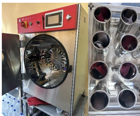
Figura 23. Tint control utilizado para la solidez al lavado
