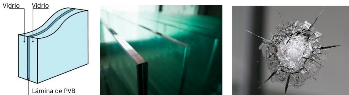
Figura 10. Representación del vidrio laminado con PVB utilizado en la industria del automóvil
