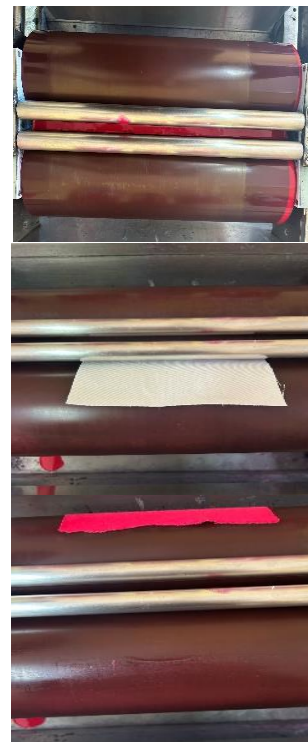
Figura 20. Foulard utilizado y muestra del proceso de impregnación.
