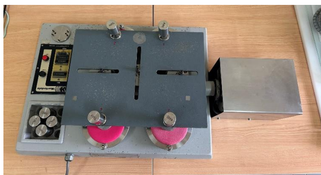
Figura 27. Martindale para prueba de resistencia al pilling
