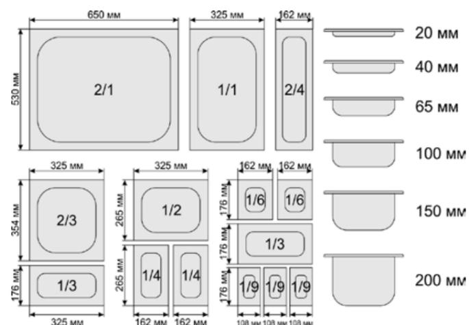
Dimensiones de bandejas del sistema GASTRONORM, aplicables a módulos de otros aparatos.
