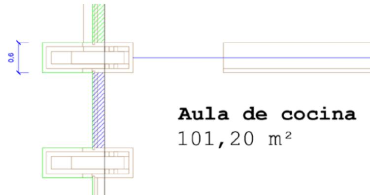
•En el local de riesgo especial 'Aula de Cocina', la superficie de fachada con resistencia <EI60 ajena al recinto más próxima a las de éste se encuentra adyacente a aquellas, separada por una pilastra de ancho 0,60m (>0,50).
