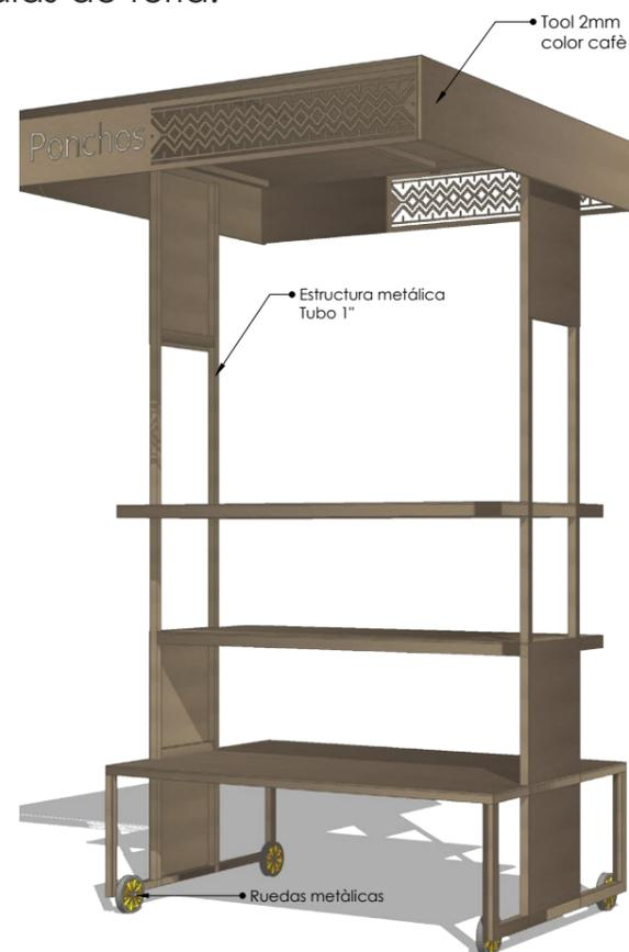
Fig. 67: Detalle prototipo de mobiliario móvil - Elaboración Propia
