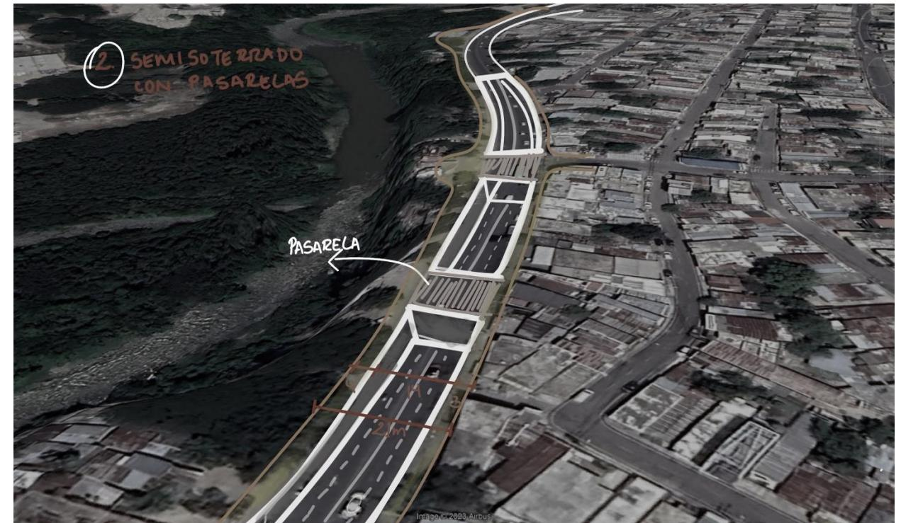
Figura 79. Soterramiento parcial del vial Av. Circunvalación conectado con pasarelas - Elaboración propia
