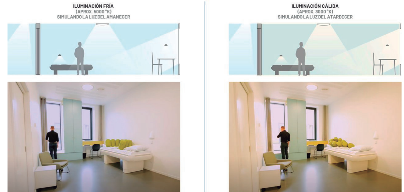
Fig. 30 Iluminación regulable en habitación del Hospital Psiquiátrico Vejle.
