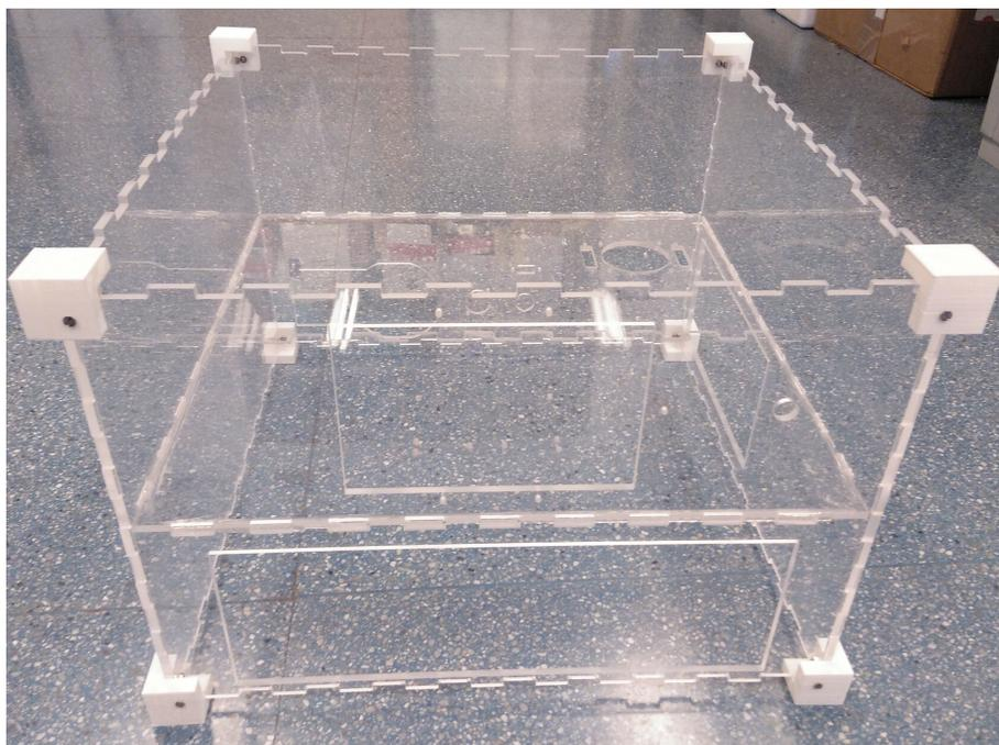
*Figura 2.40: Encapsulado del equipo al finalizar el corte de piezas y tras el ensamblaje de las partes básicas.*
