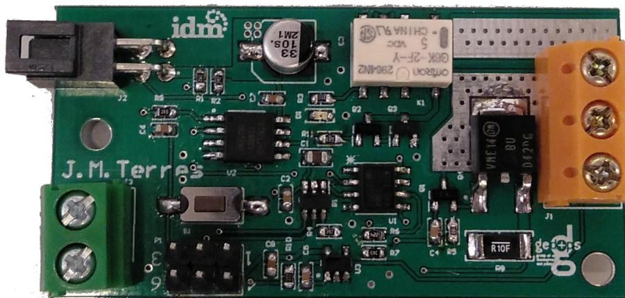
Figura 2.30: Implementación del módulo de control del láser.
