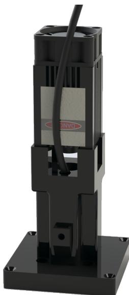
*Figura 2.21: Render del cabezal láser. En la parte inferior, el soporte fabricado en PLA. De la parte central surge un cable correspondiente a la cámara USB. En la parte superior se encuentra el módulo láser JLM8050ZB-J2Y5.*
