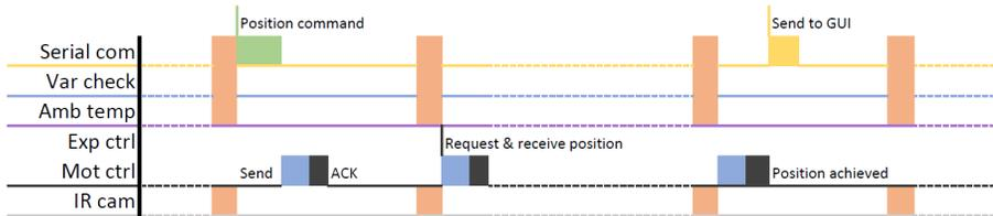
Figura 2.24: Diagrama de tiempos del firmware del módulo principal cuando se recibe desde la GUI un comando de posicionamiento.
