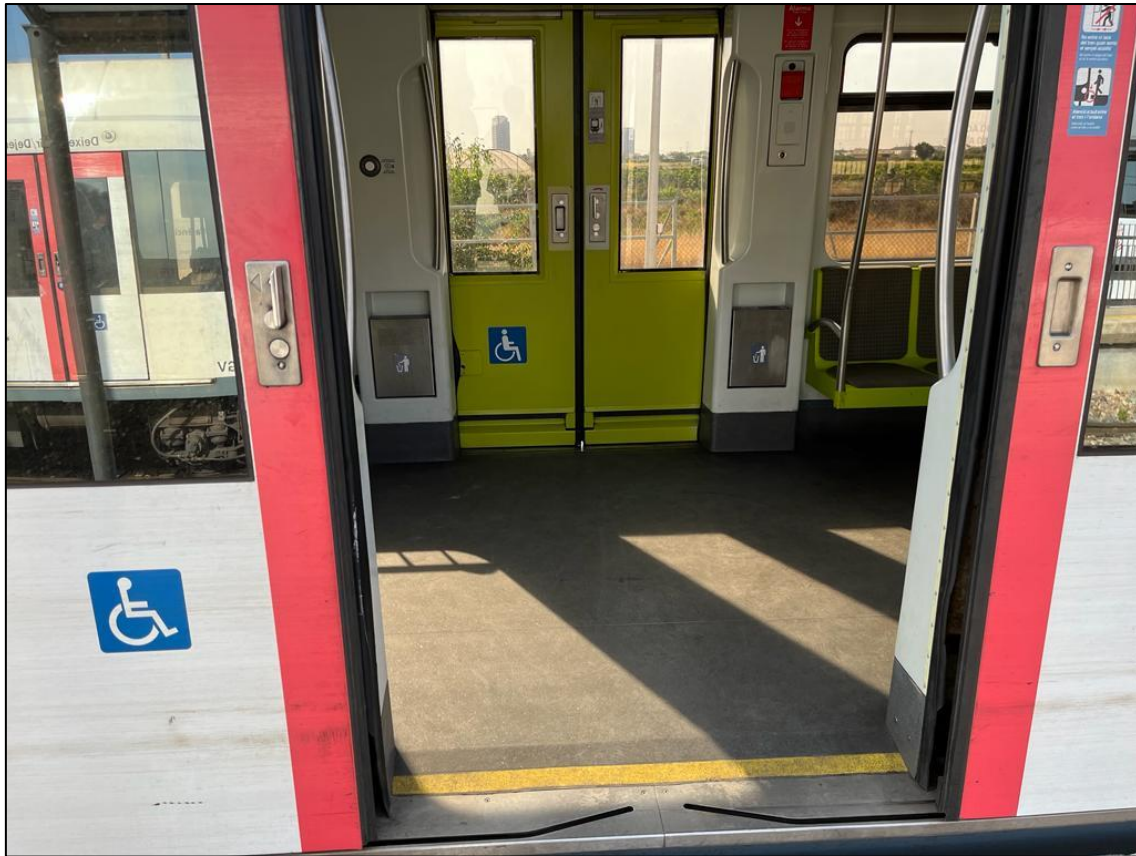
Figura 57. Acceso andén-metro a mismo nivel (Fuente: FGV)
