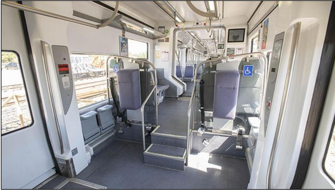
Figura 9. Imagen interior de los espacios reservados para PMR en un tren de la serie 464 (Fuente: Renfe)
