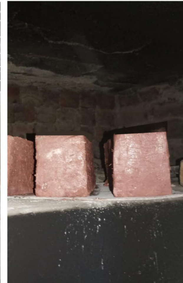
figura 75: Se pone los ladrillos en un horno que esta 200 grados centigrados para un mejor secado por 3 días.
