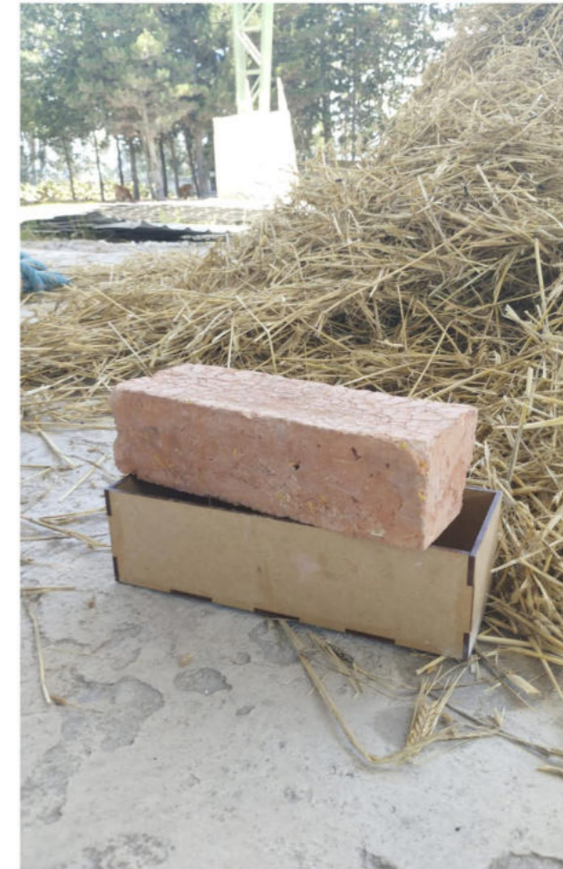
figura 76: despues del secado de ladrillo esta listo para utilizarse en la elaboracion de tabiquerias.
