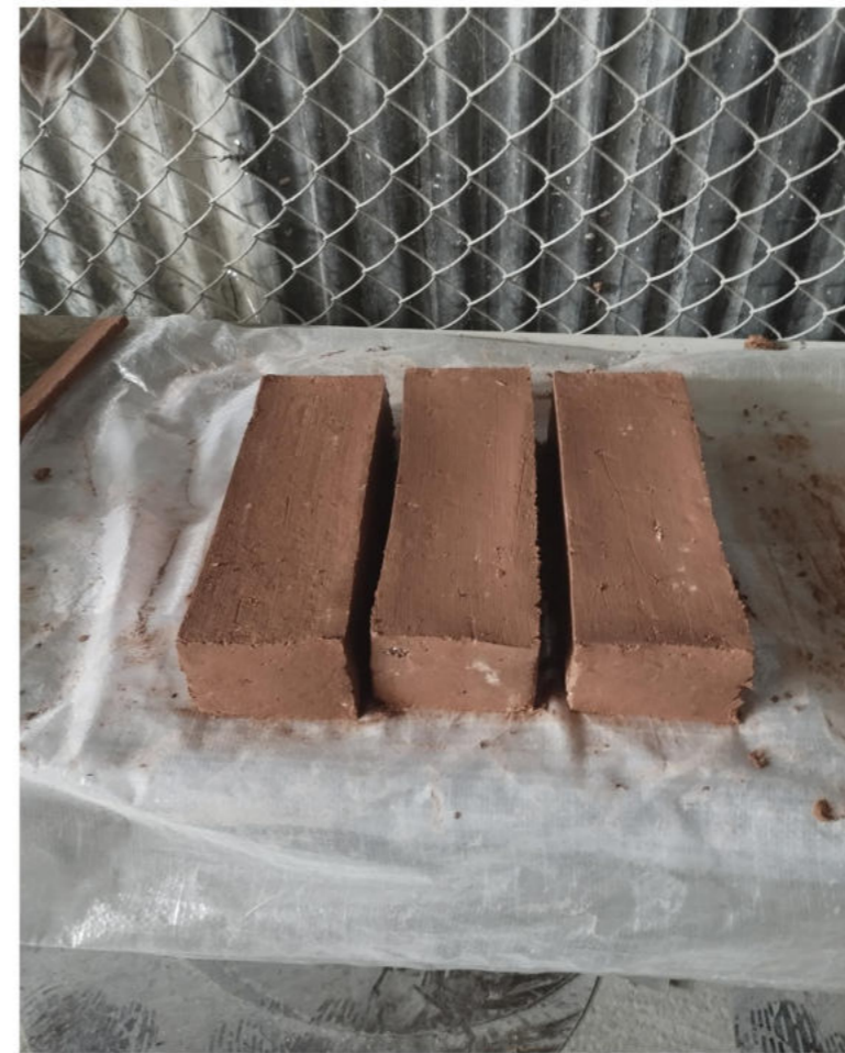
figura 74: Se retira el molde y se deja secar los ladrillos por 7 días
