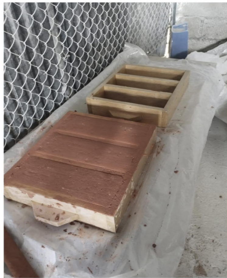
figura 73: Se utiliza unos moldes de madera para realizar tres ladrillos y se vierte la mezcla del ladrillo de cal y se golpea la mezcla para que no tengo porosidad.
