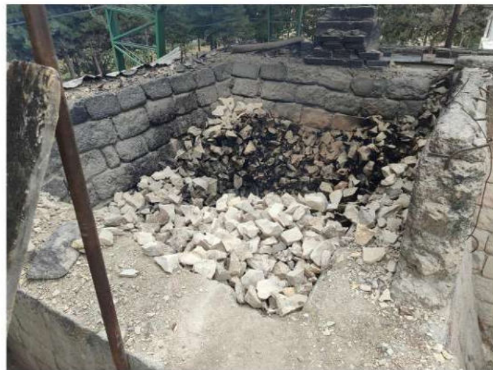
figura 56: Horno de cal de proceso continuo.
