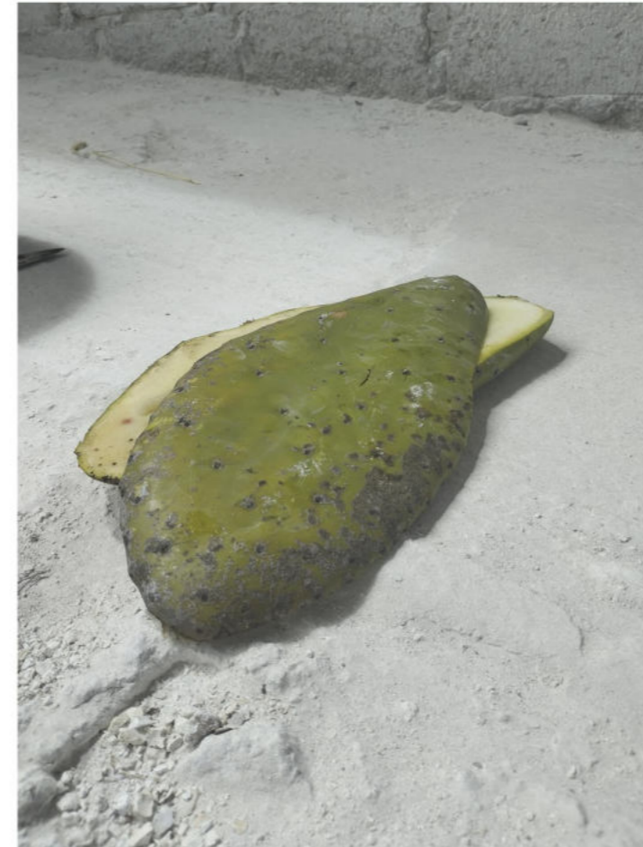
figura 67: Goma de Tuna: Se utiliza como estabilizante, para disminuir la erosión provocada por las lluvias, es decir, cumple con una función de impermeabilizante.
