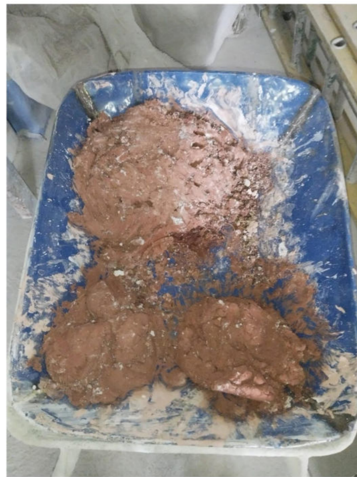
figura 72: Se utiliza una batidora para mezclar todos los materiales y se deja reposar la mezcla por 1 días.
