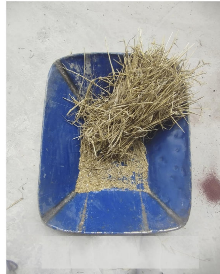
figura 68: Paja de cebada: Se utiliza como alivianamiento, para reducir el peso, al mismo tiempo que se mejora la capacidad aislante térmica y acústica.
