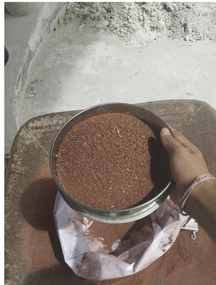
figura 66: Tamizado de la arcilla: La arcilla se extrae de la cantera cercana y se pasa por un tamis con granulometría de 0,1 milímetros
