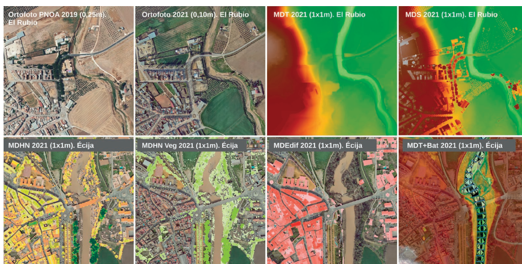
Figura 5. Ejemplos de ortofotos y productos altimétricos obtenidos (en dos núcleos urbanos Écija y El Rubio) en contraste con la ortofoto PNOA 2019.
