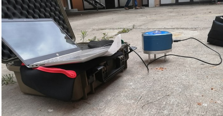
Figura 2-9 Equipo de medida HVSR (marca Dolang Geophysical Ltd., modelo JEA) uno de los empleados en esta investigación. Compuesto por tres geófonos de 2.0 Hz de frecuencia natural, y donde se puede observar las picas de implantación y el nivel de precisión en la parte superior.
