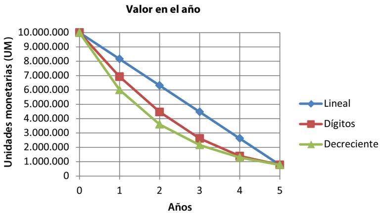
**PROBLEMA 17.** De entre las siguientes máquinas de obras públicas se desea averiguar aquella cuyo coste horario por amortización, calculado por el método de depreciación lineal, sea menor.
