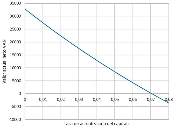
**PROBLEMA 7.** Calcular el VAN y el TIR de una inversión realizada en un equipo empleado en la construcción en un entorno inflacionista. La tasa de inflación es  $g = 8,5 \%$  y la empresa incrementa cada año el valor nominal de los flujos netos de caja en un  $f = 6,0 \%$ . La actualización o coste del capital es  $i=0,063$ . Los flujos de caja para los seis años de la inversión son los que figuran en la siguiente tabla:
