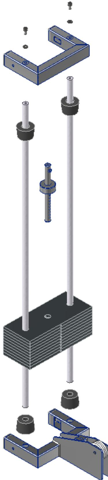
*Ilustración 26 - Explosión de la estructura con guías para la elevación de las placas de pesos*
