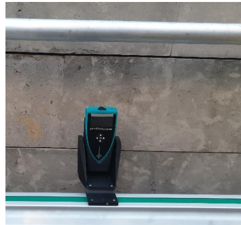
Ilustración 63: Sonda magnética sobre actuador lineal.
