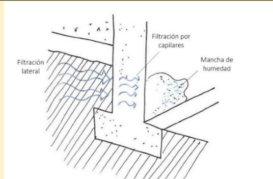
Figura 3. Proceso de filtración de aguas subterráneas (FCCCO)
