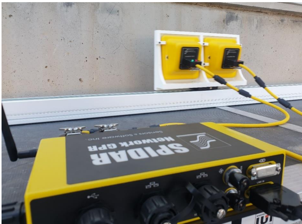
Ilustración 65: Pruebas del georadar sobre el actuador lineal.
