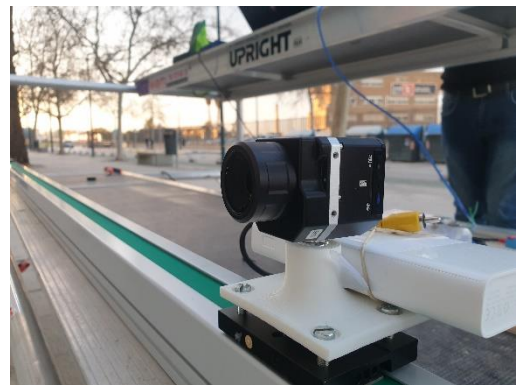
Ilustración 57: Pruebas de la cámara termográfica en el actuador.
