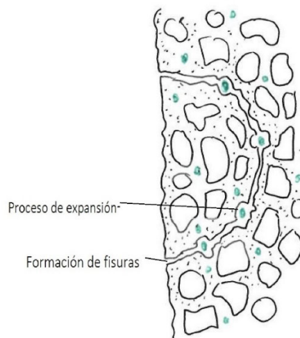
Figura 2. Proceso de formación de fisuras por ataque de sulfatos(FCCCO)
