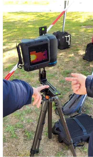
Ilustración 126: Cámara termográfica montada en el trípode.
