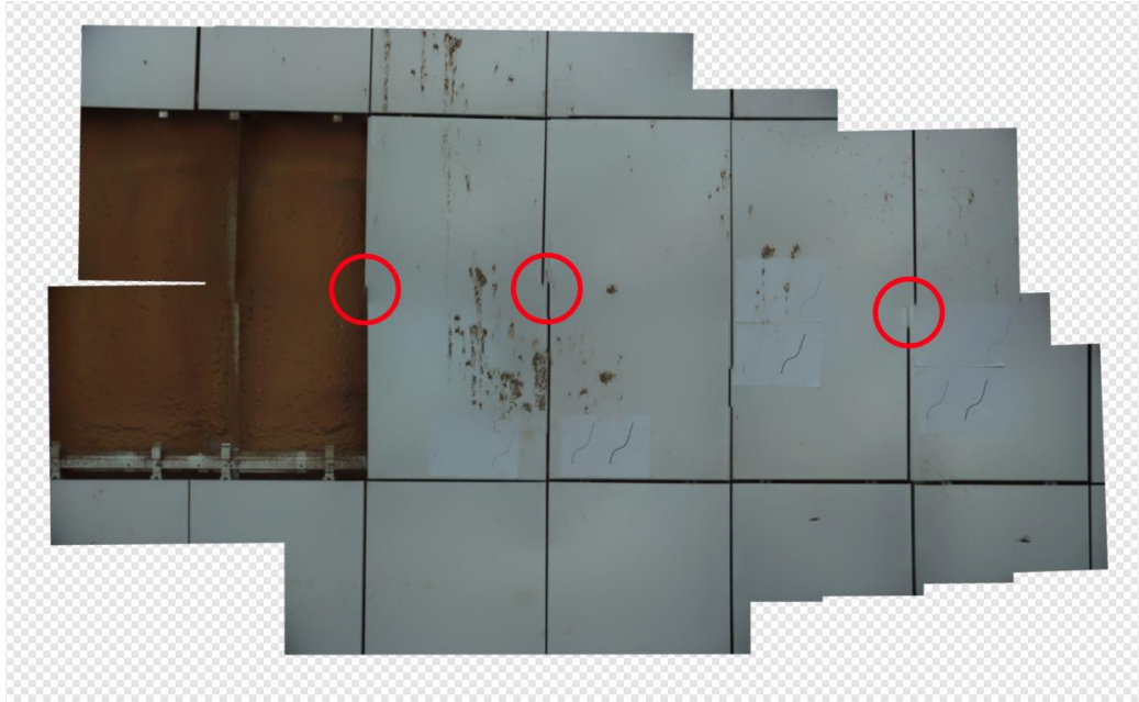
Ilustración 141: Errores de empalme por paralaje.
