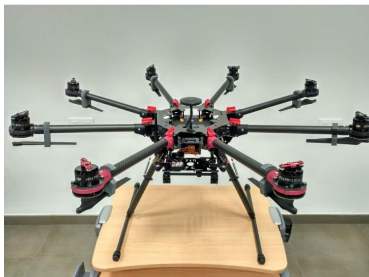
Ilustración 50: Plataforma voladora de fibra de carbono.
