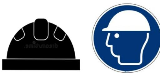
Figura 61. Uso de cascos: pictograma no normatizado(Fuente:dreamstime) vs. normatizado ISO (Fuente ISO 7010:2021)
