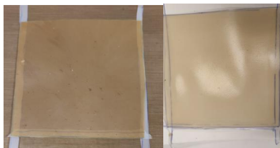
Figura 1. Bolsas de PHBV con las tiras de PCL para el sellado de los laterales, antes y después del sellado.
