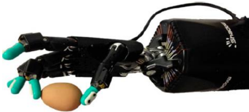
Figura 15.- El sentido del tacto, crucial para una exitosa interacción hombre-maquina, sensor de presión integrado en la mano de un robot [83].
