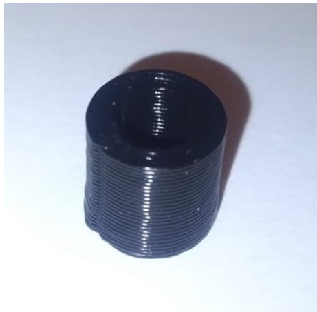
Figura 54.- Cilindro impreso en PLA.
