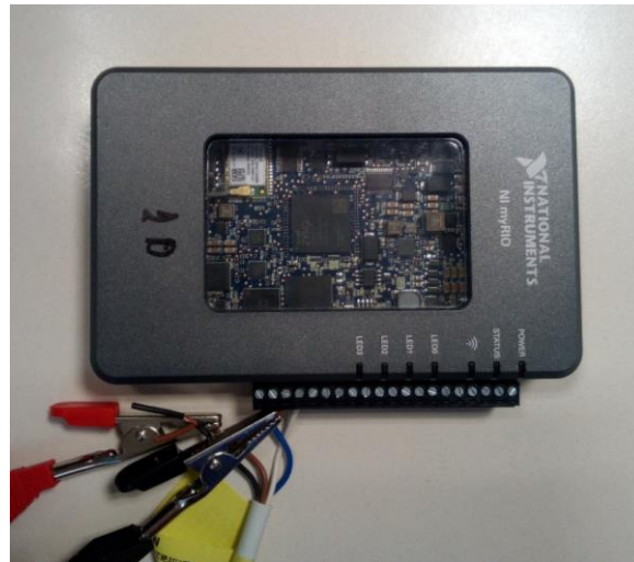
Figura 57.- Sistema embebido "MyRIO" de National Instruments.
