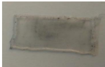
Figura 27.- Encapsulado de etileno-vinil-acetato (EVA).
