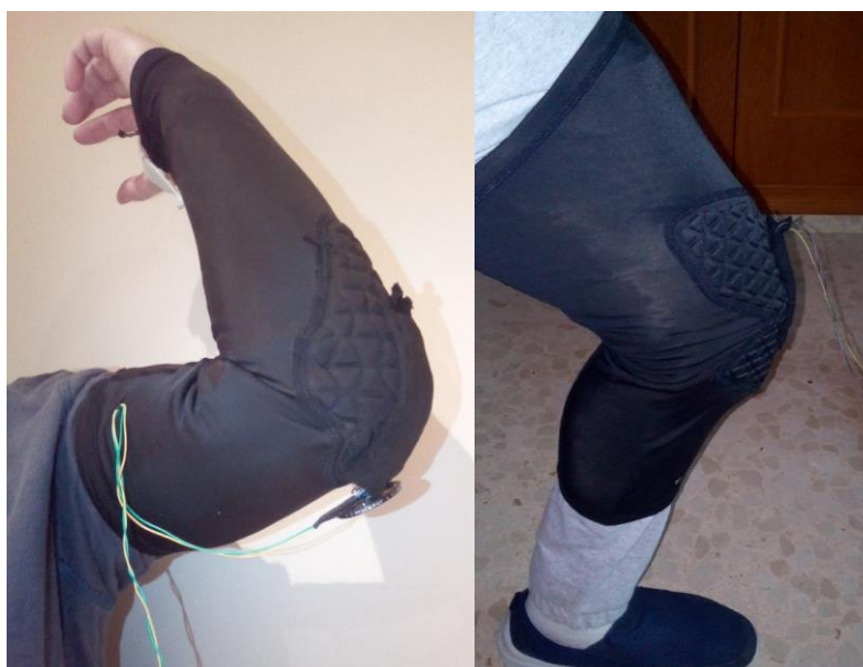
Figura 125.- Prototipo aplicado de la monitorización de codo y rodilla.
