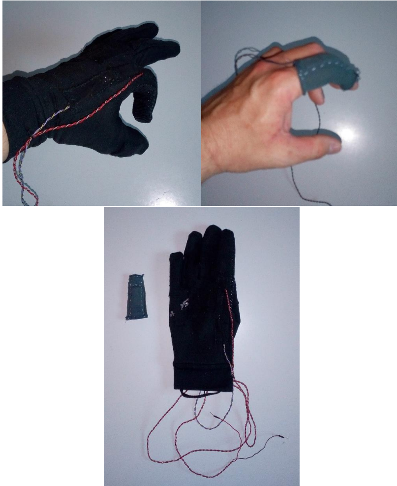
Figura 118.- Diferentes formas de integrar el sensor en un tejido.
