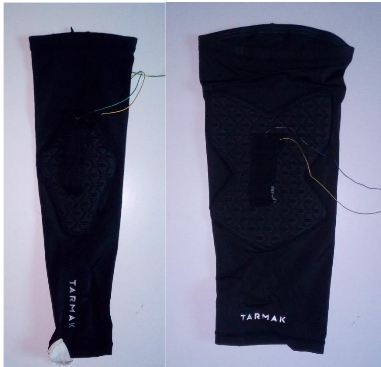
Figura 124.- Codera y rodillera respectivamente donde se ha integrado el sensor.
