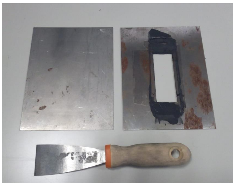
Figura 33.- Material utilizado para la deposición, rasqueta y stencils.
