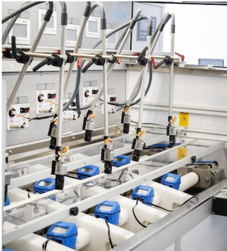
**Figura 12** Banco de ensayos de contadores de agua en GOlab. Fuente: (GOlab, s.f.)
