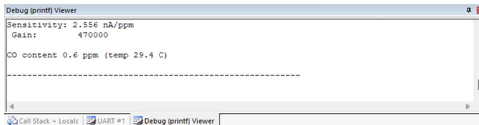
Figura 58. Salida del debugger de Keil para una medición de CO en un ambiente sin presencia de este gas
