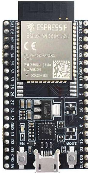
Figura 18. Alternativa 3 de control: ESP32-DevKitC-32E <sup>14</sup>
