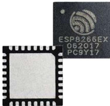
Figura 45. Chip ESP8266EX <sup>29</sup>
