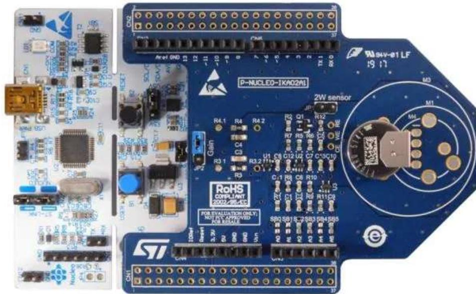
Figura 35. Placa STM32L053R8 junto al módulo de expansión P-NUCLEO-1KA02A1 <sup>27</sup>
