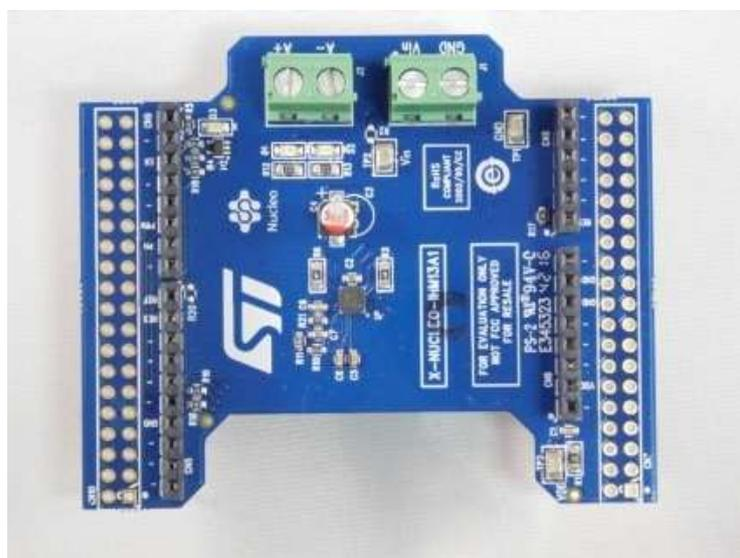
Figura 30. Alternativa 1 para el control de motores: Placa X-NUCLEO-IHM13A1<sup>25</sup>
