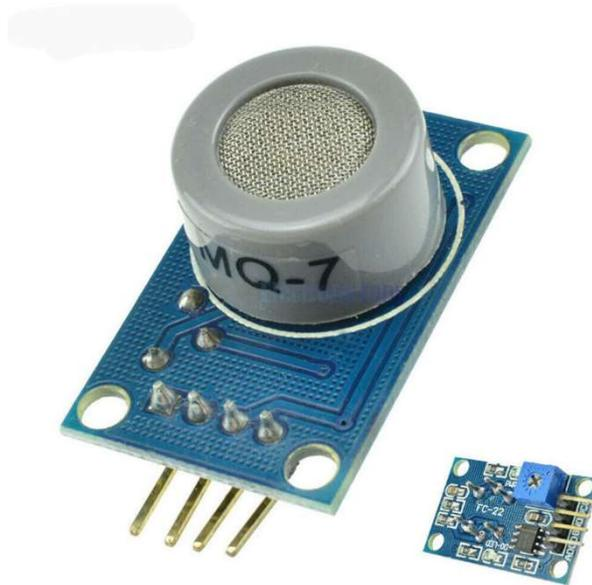
*Figura 3. Alternativa 1 de monitorización de CO: Sensor de gas MQ-7.<sup>3</sup>*
