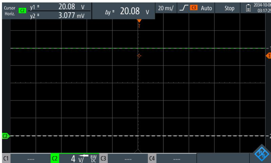
**Figura 4.6:** Tensión de salida del regulador *Flyback* de la tarjeta de potencia ajustada
