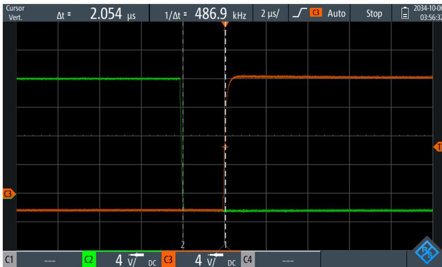
**Figura 4.13:** Tiempo muerto entre transistores de la misma rama
