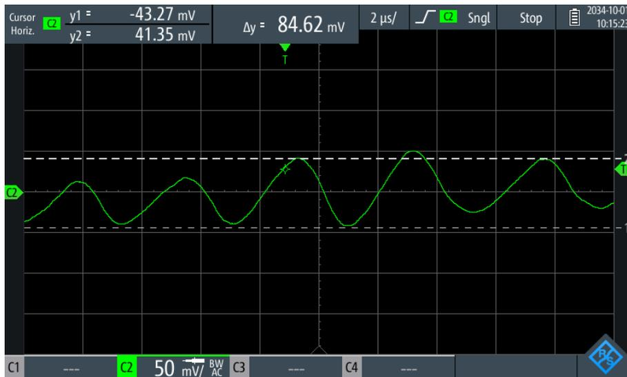
**Figura 4.4:** Rizado de la tensión de salida del regulador de 16 V de la tarjeta de control
