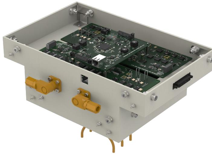
**Figura 3.18:** Caja del inversor con las tarjetas ensambladas
