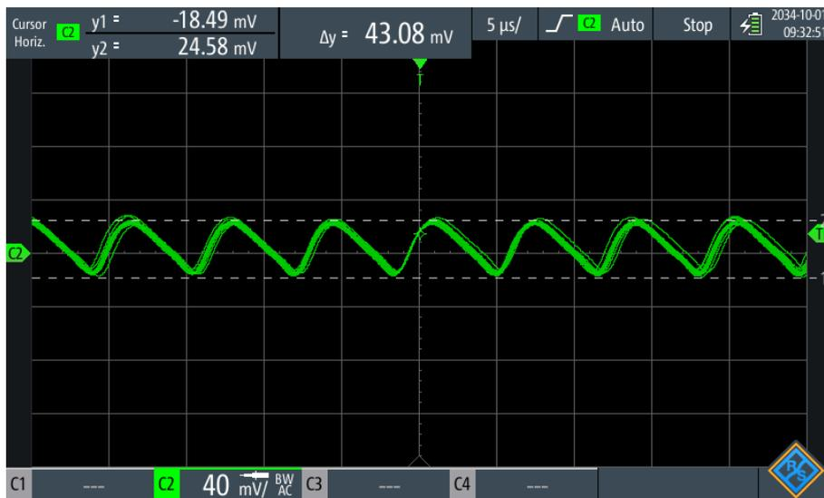
**Figura 4.2:** Rizado de la tensión de salida del regulador de 5 V de la tarjeta de control
