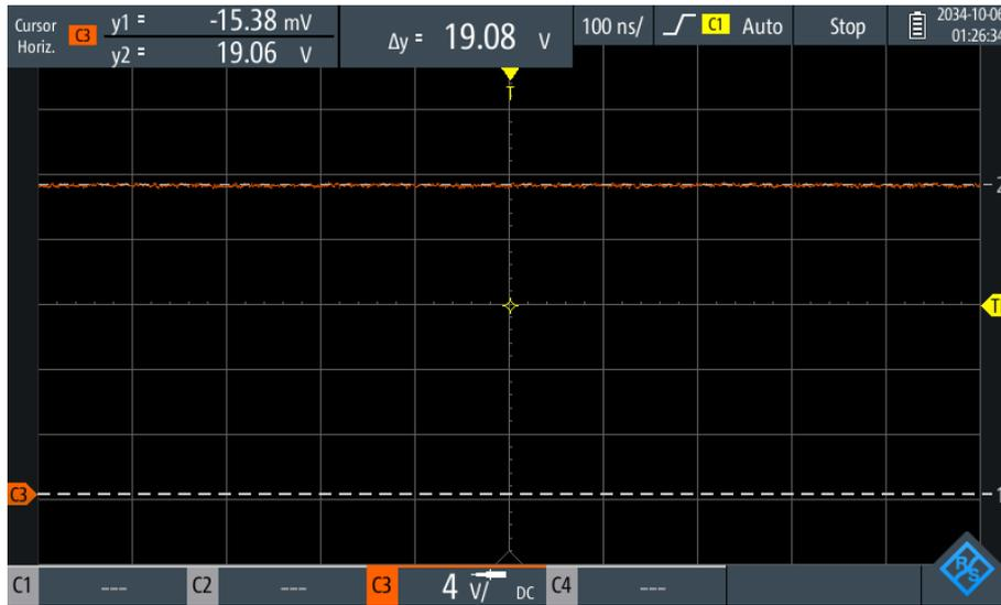
**Figura 4.5:** Tensión de salida del regulador *Flyback* de la tarjeta de potencia
