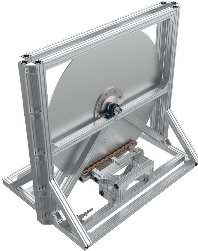
**Figura 4.17:** Volante utilizado para las pruebas del sistema de tracción
