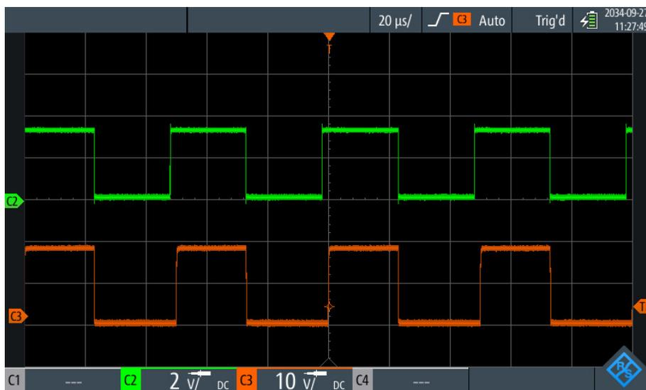
**Figura 4.10:** Señal proveniente del microcontrolador y salida del controlador de puerta
