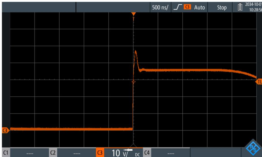
**Figura 4.9:** Detalle del nodo de conmutación del regulador *Flyback*
