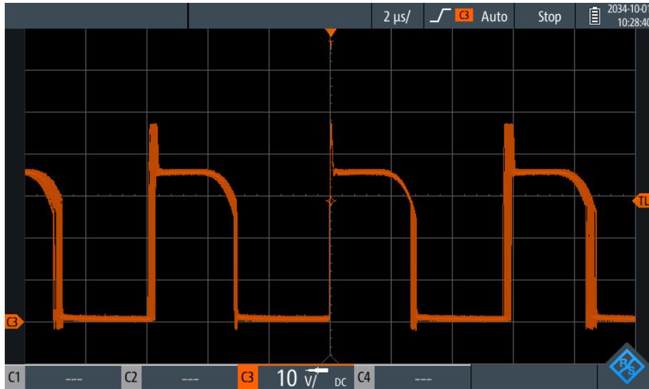
**Figura 4.8:** Nodo de conmutación del regulador *Flyback*
