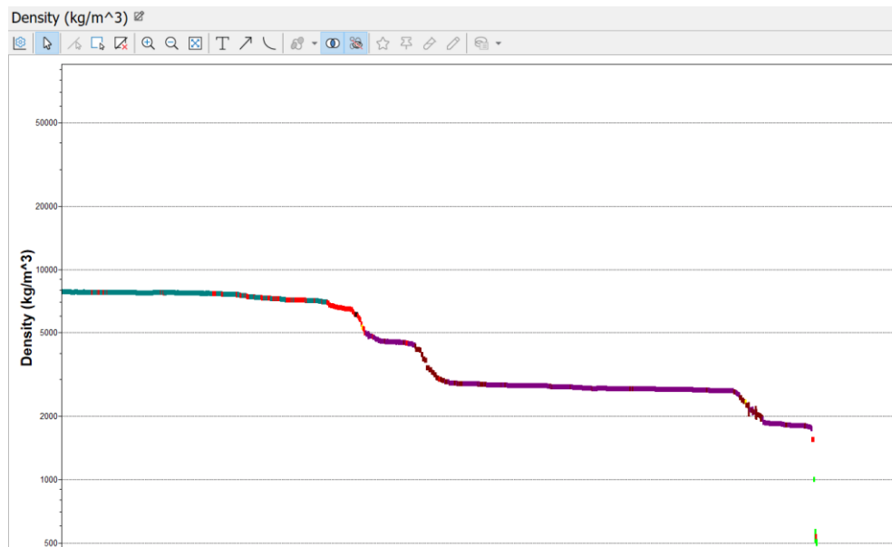
Ilustración 4. ETAPA 2: Materiales filtrados por una densidad máxima de 7035,92 kg/m3
