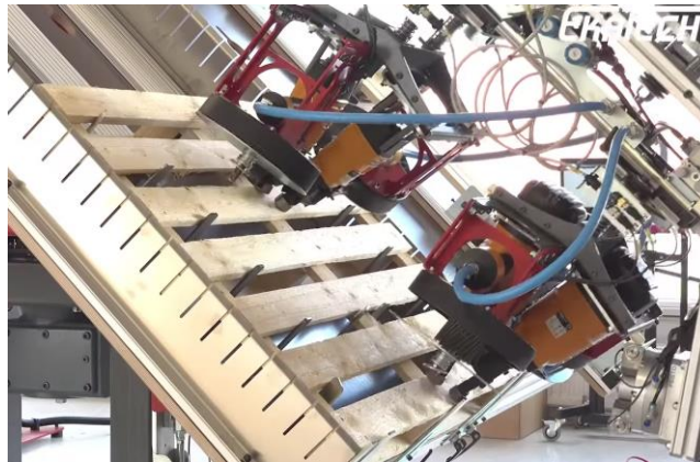
Ilustración 3. Sistema de clavado de RN4017
