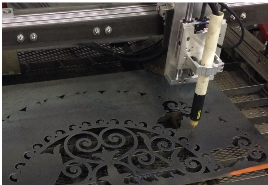
Ilustración 6. Corte por arco de plasma por CNC
