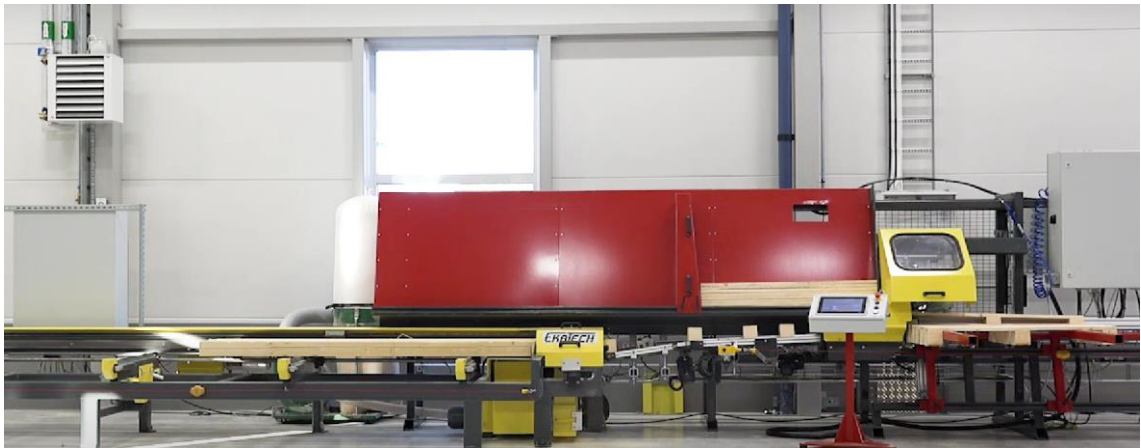
Ilustración 6. LM3017-BC con opción de cortadora de perfil de madera
