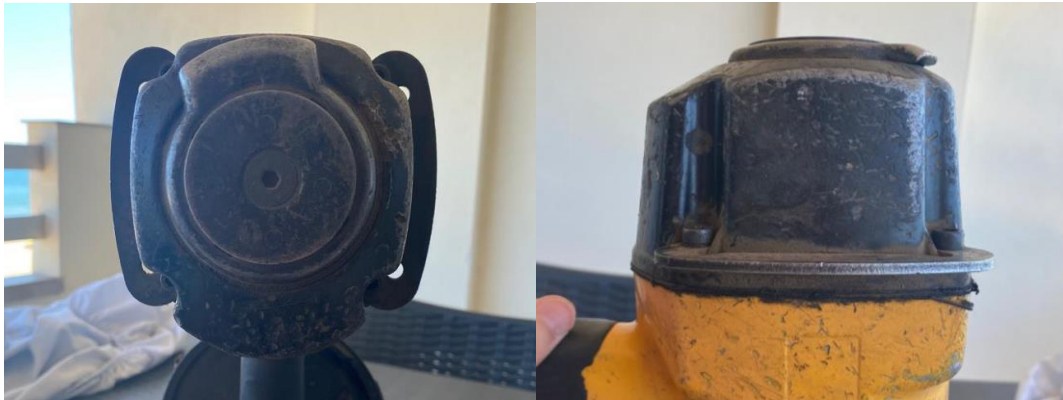
Ilustración 11. Geometría real final de acople de patillas a pistola
