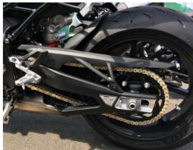
Figura 1: Sistema de transmisión por cadena de una motocicleta
