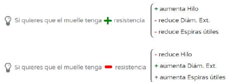
Figura 20: Esquema del comportamiento de un muelle según su geometría
