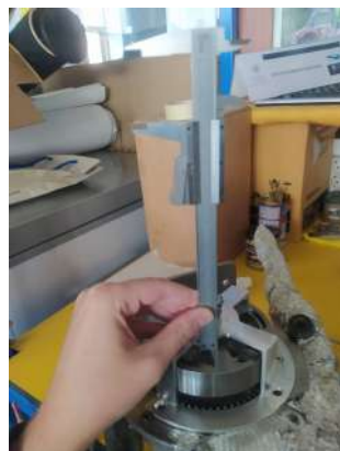
Figura 38: Distancia entre el volante de inercia y la parte interior de la campana
