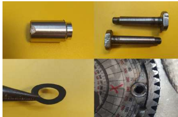
Figura 35: Deformaciones y desgastes en piezas del anclaje de las mazas
