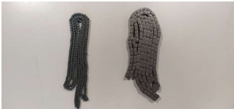
Figura 57: Cadenas de paso 6.35mm y 9.525mm del taller
