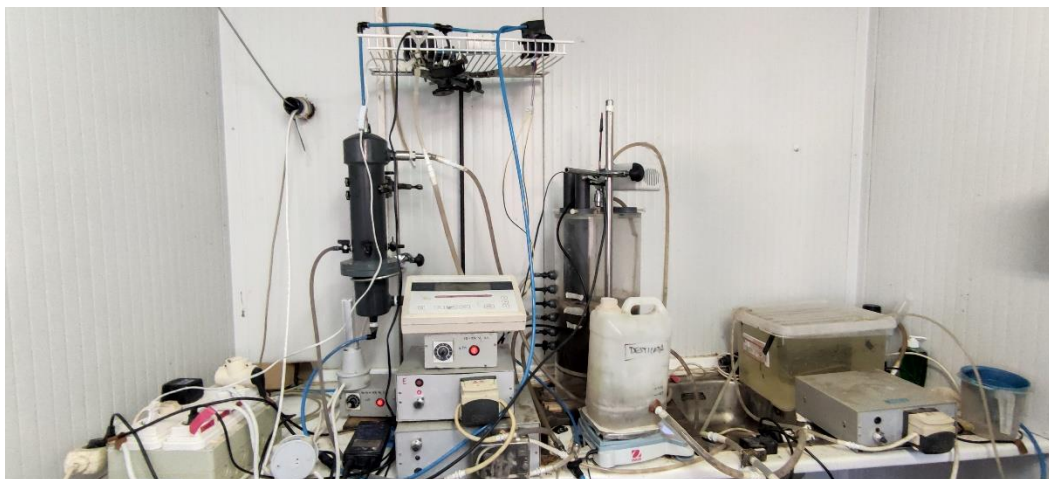
Figura 6.2. Fotografía del montaje del reactor SBR con membrana de Ultrafiltración
