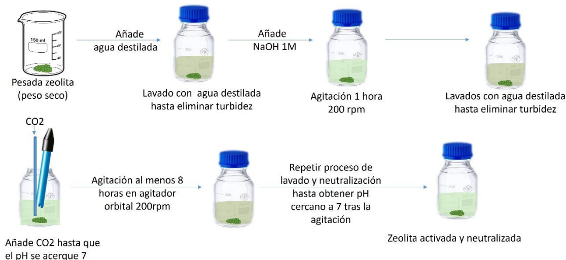
Figura 8.3. Proceso de activación de las zeolitas con NaOH
