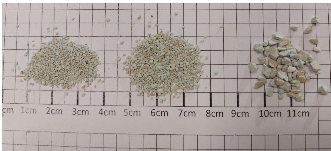
Figura 8.1. Tamaño de la zeolita natural empleada en este capítulo
