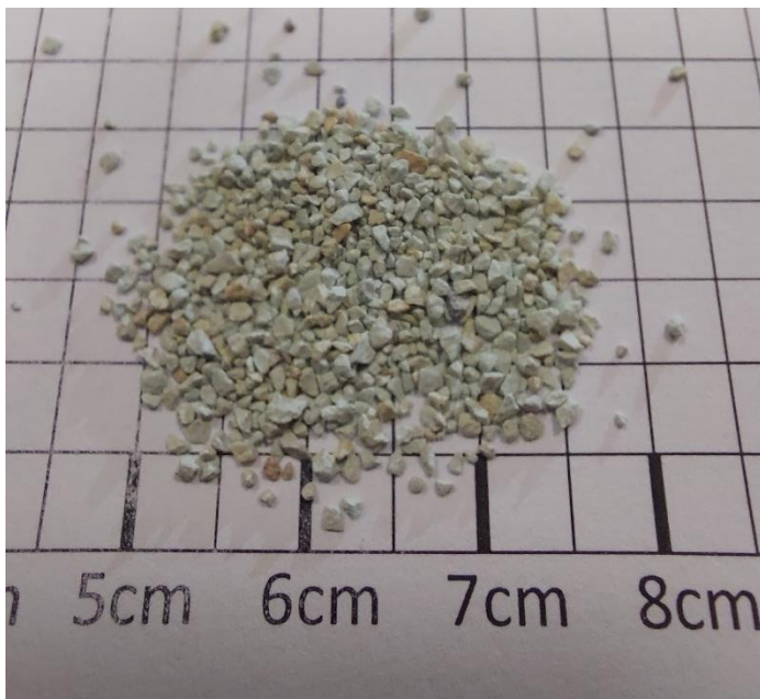
Figura S 8.2. Detalle de la zeolita natural de 0.6-1.8 mm
