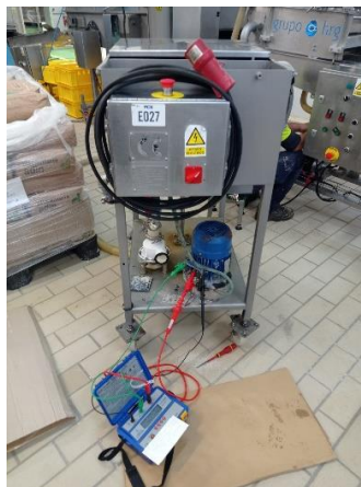
Figura 39: Medición de Resistencia de aislamiento en motor asíncrono de mezcladora de encolante. Fuente: [propia]
