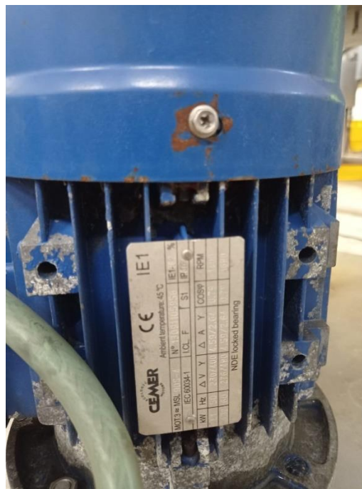
Figura 67: Placa de características motor CEMER
