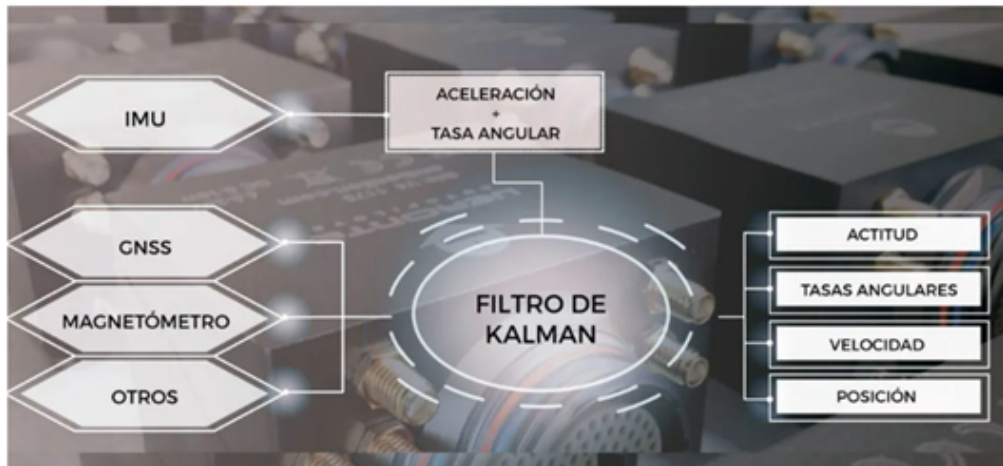
Figura 5.36: Funcionamiento de los Sistemas de Navegación Inerciales (INS). Esquema del flujo de datos procedente de la IMU y de otros sensores para estimar posiciones, velocidades, actitudes y otros parámetros relativos a la navegación de los UAS mediante el filtrado de Kalman. [84]
