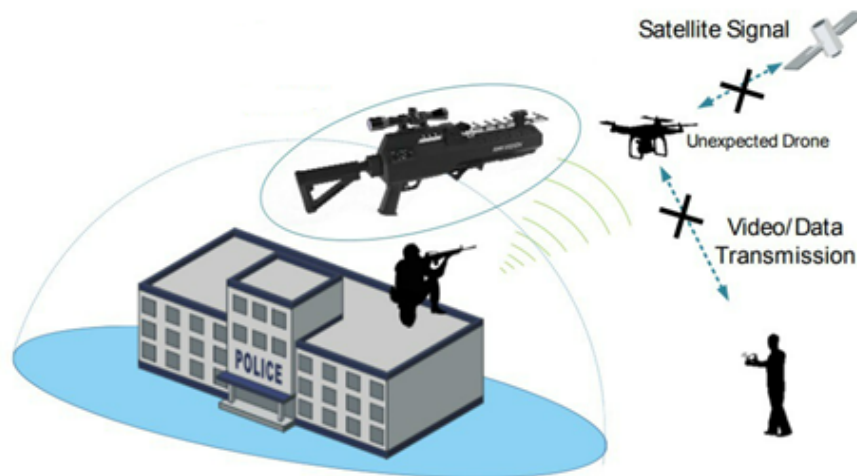
Figura 5.50: Posible situación en la que se emplea un sistema antidron tipo pistola para inhibir las señales que recibe el dron. [117]
