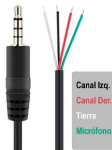
Fig. 8 Ejemplo de color del cableado.
