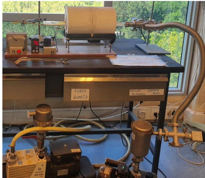
Figure.III-7: Image du dispositif de recuit effectué dans un tube de quartz
