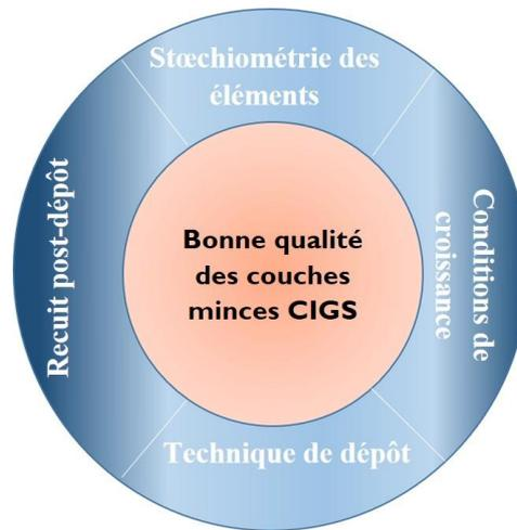
Figure.III- 2: Schéma montrant la relation entre le processus d'élaboration et la qualité des couches minces CIGS
