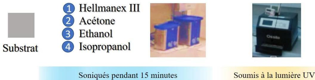
Figure.III-1: processus de nettoyage des substrats
