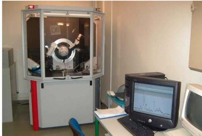
Figure.II-16: Dispositif expérimental de la technique de diffraction des rayons X [45]
