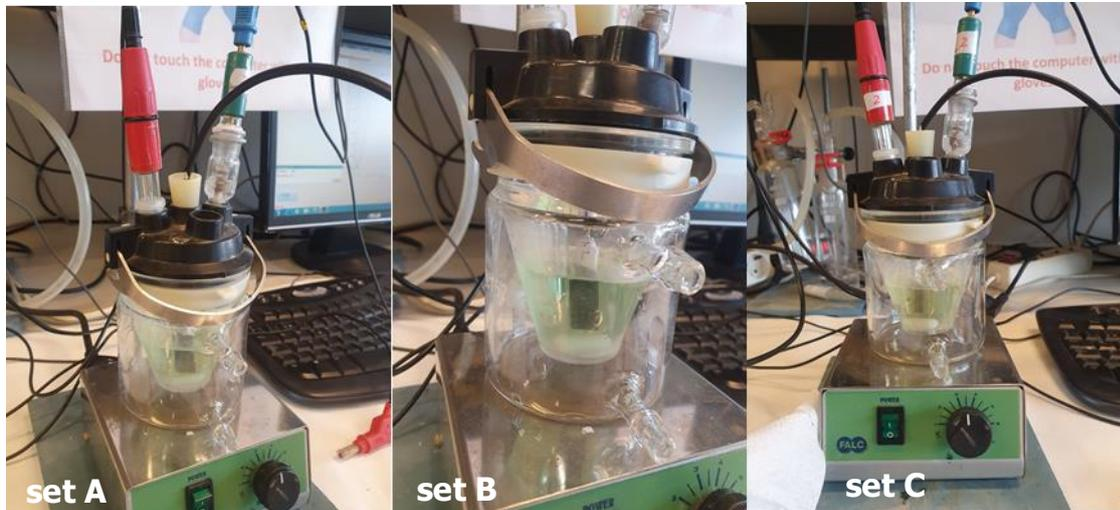
Figure.III-6: Image du dépôt de couche par électrodéposition
