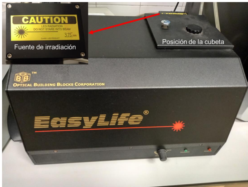
Figura 7.9. Espectrómetro de fluorescencia de tiempo resuelto EasyLife X utilizado en las medidas de tiempos de vida de fluorescencia, se señalan la fuente de irradiación (inserto) y la posición de la cubeta con la muestra.
