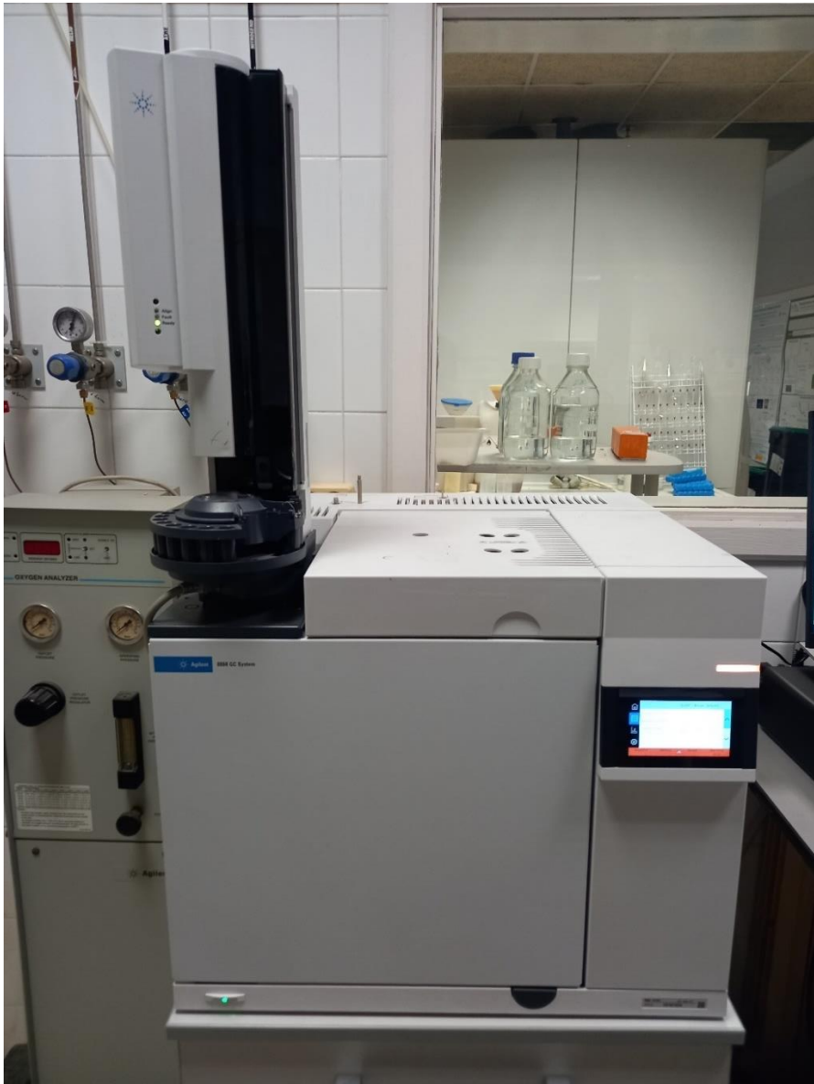
Figura 7.2. Cromatógrafo de gases modelo 8860 de Agilent
