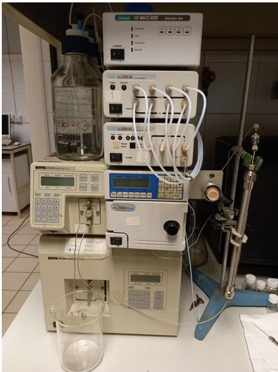
Figura 7.3. Equipo de HPLC utilizado en la separación y purificación de los compuestos caracterizados en este trabajo.
