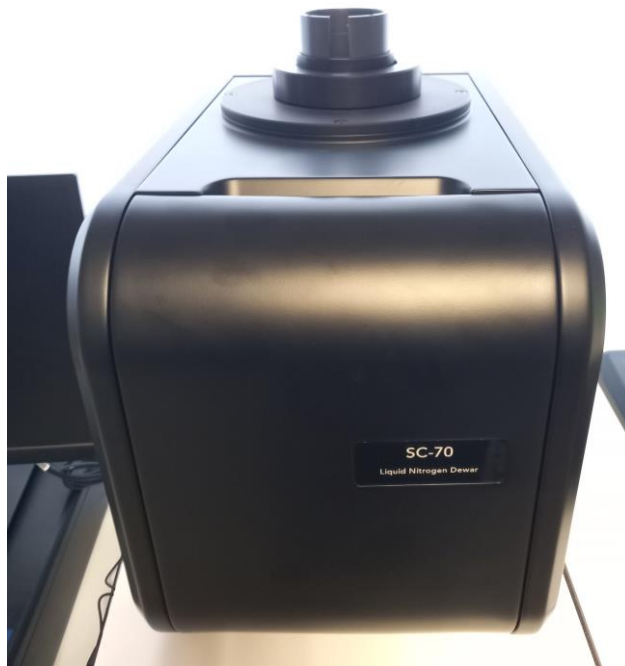
Figura 7.8. Módulo Dewar SC-70 para el espectrofotómetro Edinburgh FS5 que se utilizó en las medidas de fosforescencia.
