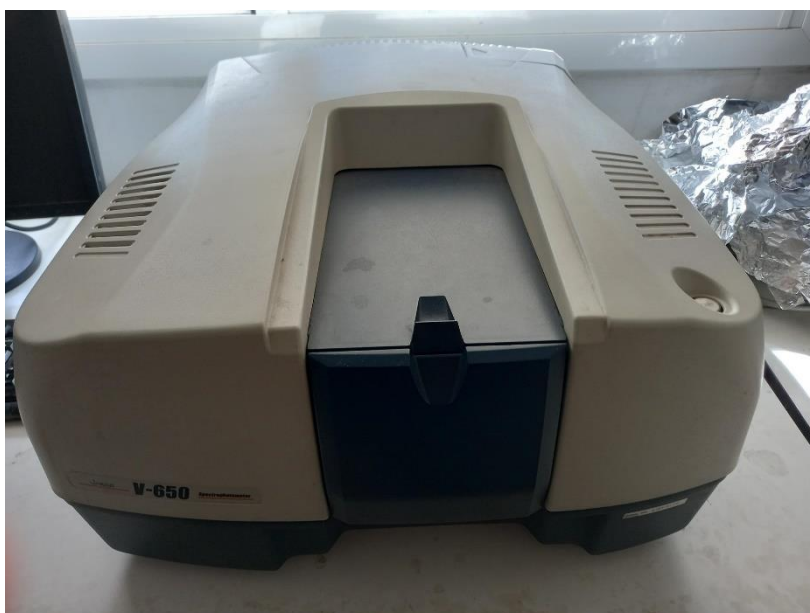
Figura 7.5. Espectrómetro de ultravioleta-visible JASCO V-650
