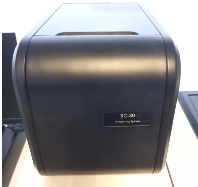
Figura 7.7. Módulo de esfera integradora SC-30 para el fluorímetro FS5 de Edinburgh
