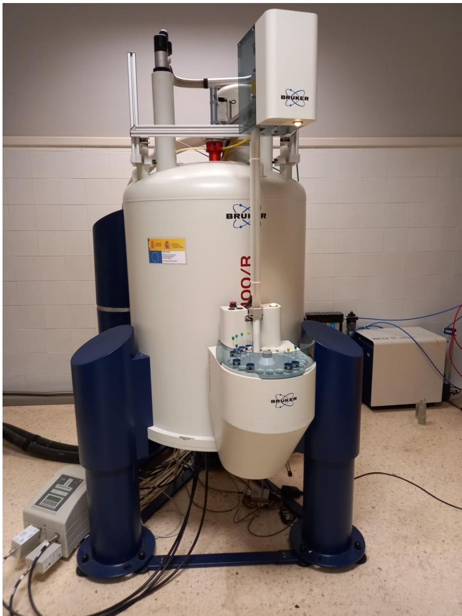
Figura 7.4. Equipo de resonancia magnética nuclear BRUKER
