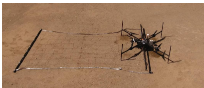
Figura 6.50: UAV captor con la red de captura instalada
