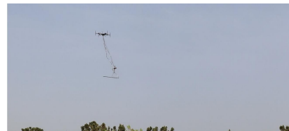
Figura 6.51: Captura de UAV hostil en vuelo por el UAV captor
