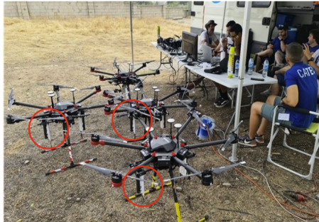
Figura 5.37: Puntos Acceso wifi integrado en UAVs
