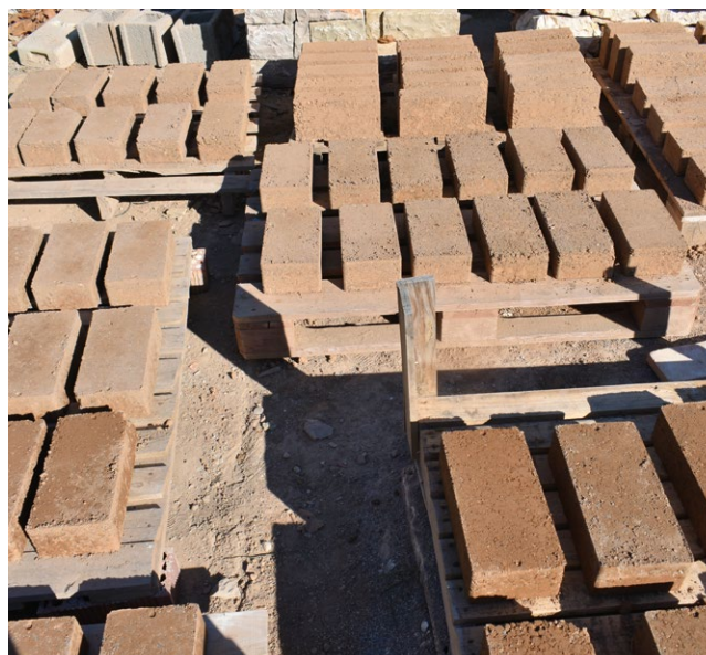
BTC fabriqués à l'Universitat Politècnica de València.
