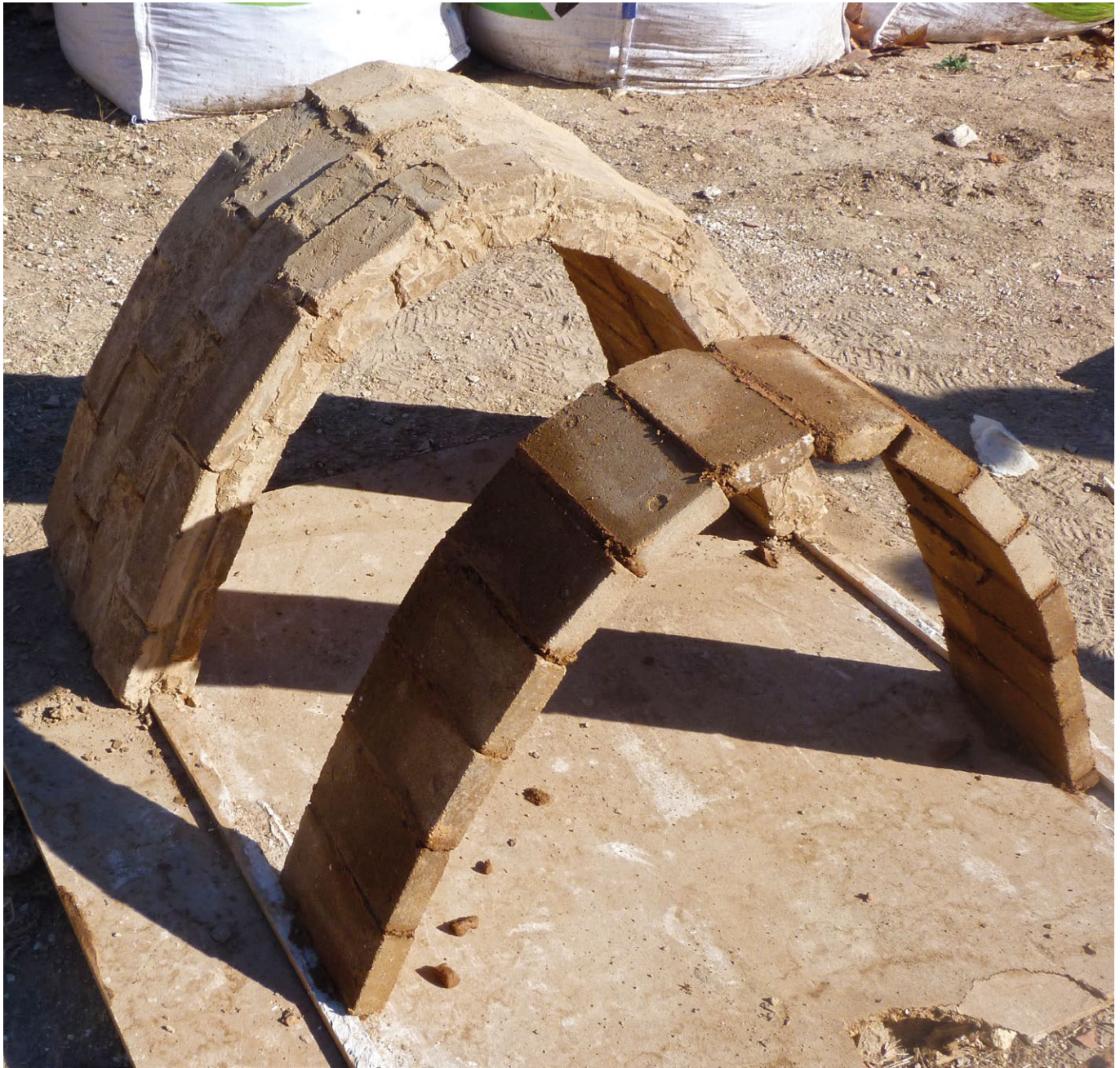
Deux prototypes de voûtes plates en terre.
