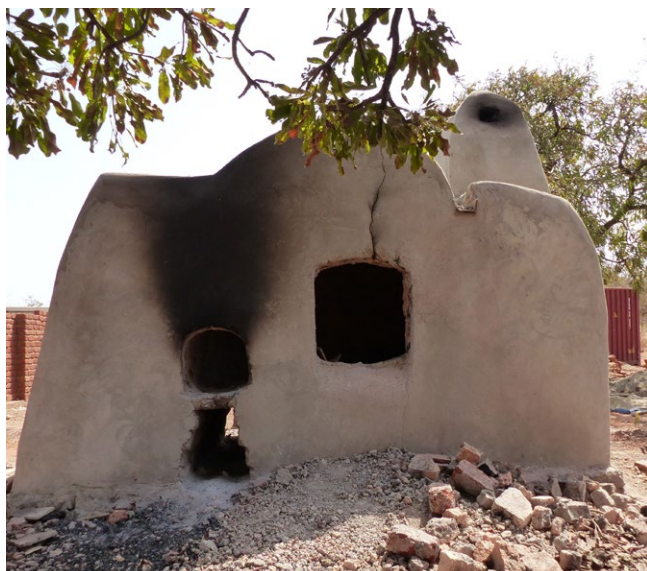
Four à céramique moderne pour la cuisson de dalles au pied d'un chantier de construction.
