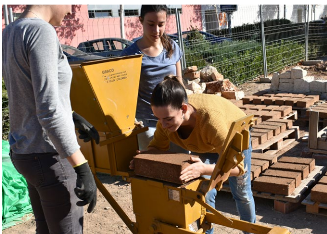
Presse manuelle pour la production du BTC. Universitat Politècnica de València.
