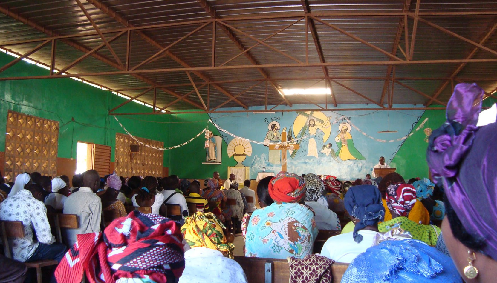
Vue intérieure d'une église rurale construite avec des blocs de ciment préfabriqués, des fermes métalliques et une toiture en tôle, lors d'une célébration dominicale.
