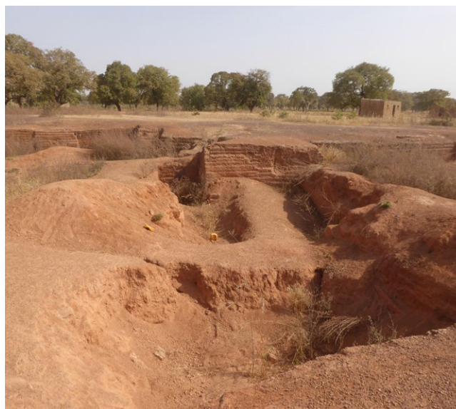
Carrière d'extraction de blocs de latérite taillés ou BTL.
