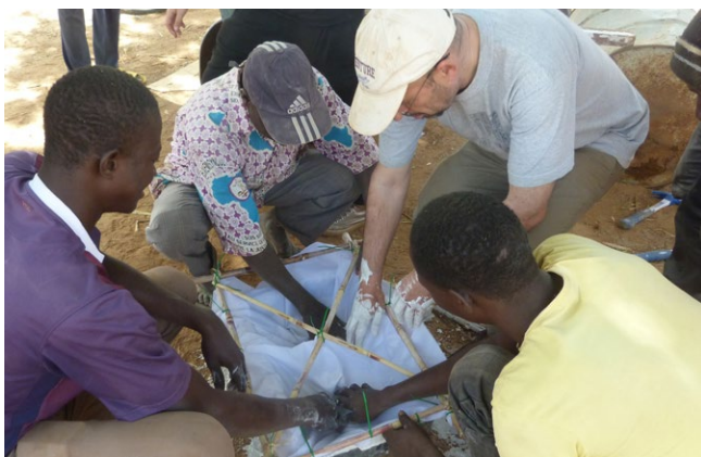
Fabrication du châssis, pose du tissu et trempage avec du plâtre.
