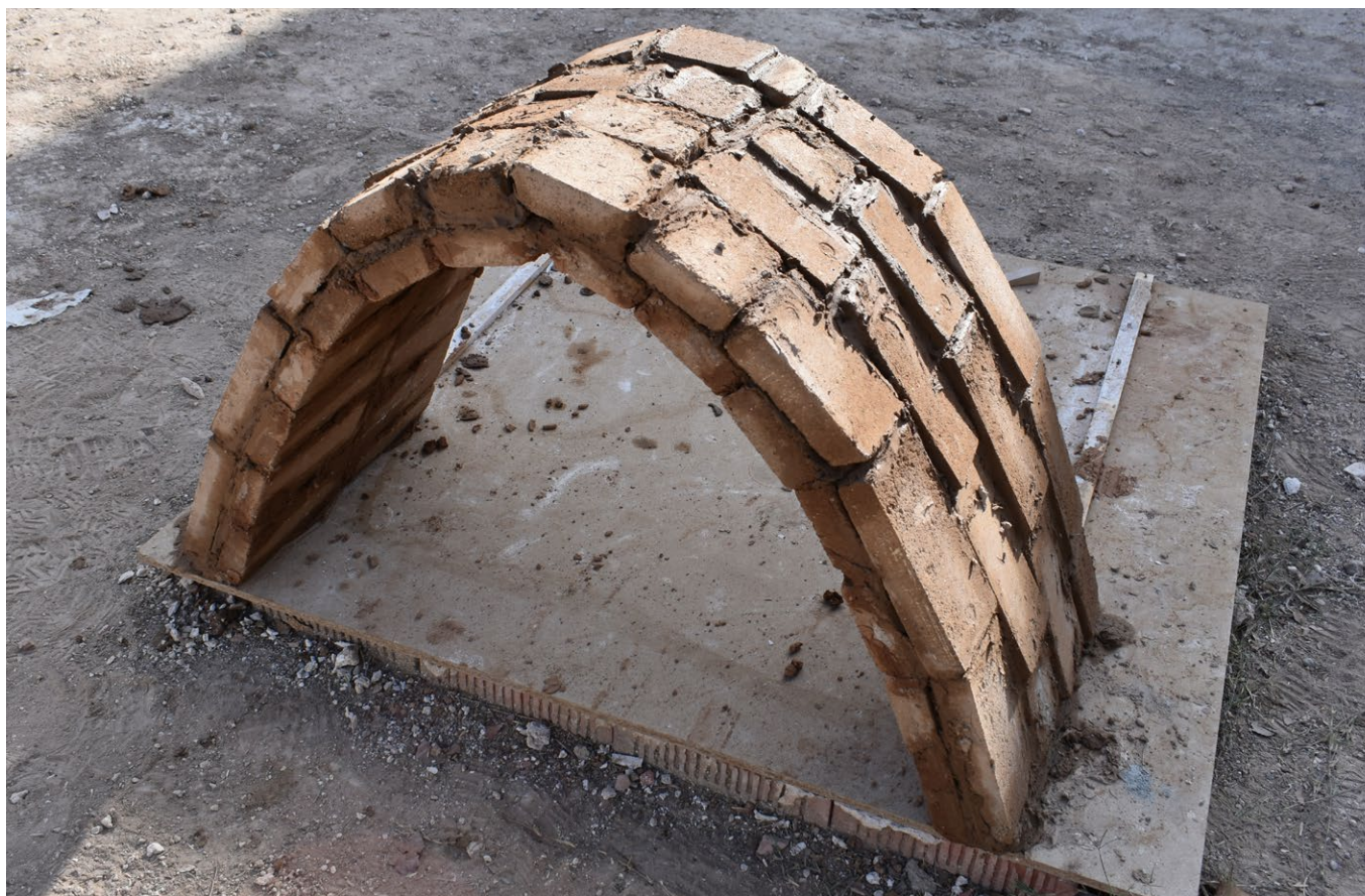
Prototype de voûte plate en BTC avec mortier de terre.
