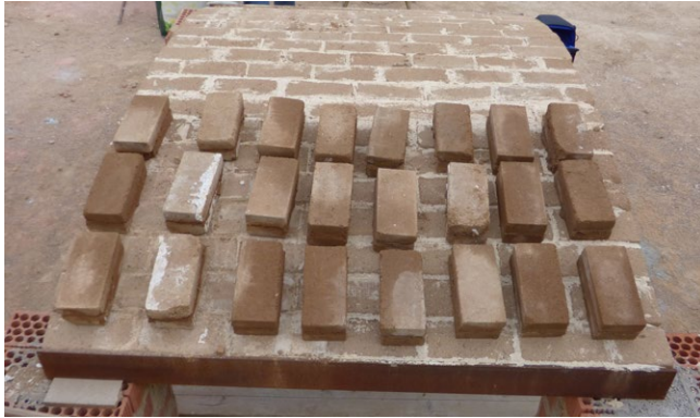
Essais d'adhérence effectués avec différents dosages de mortier pour déterminer les proportions appropriées pour la construction de la voûte.
