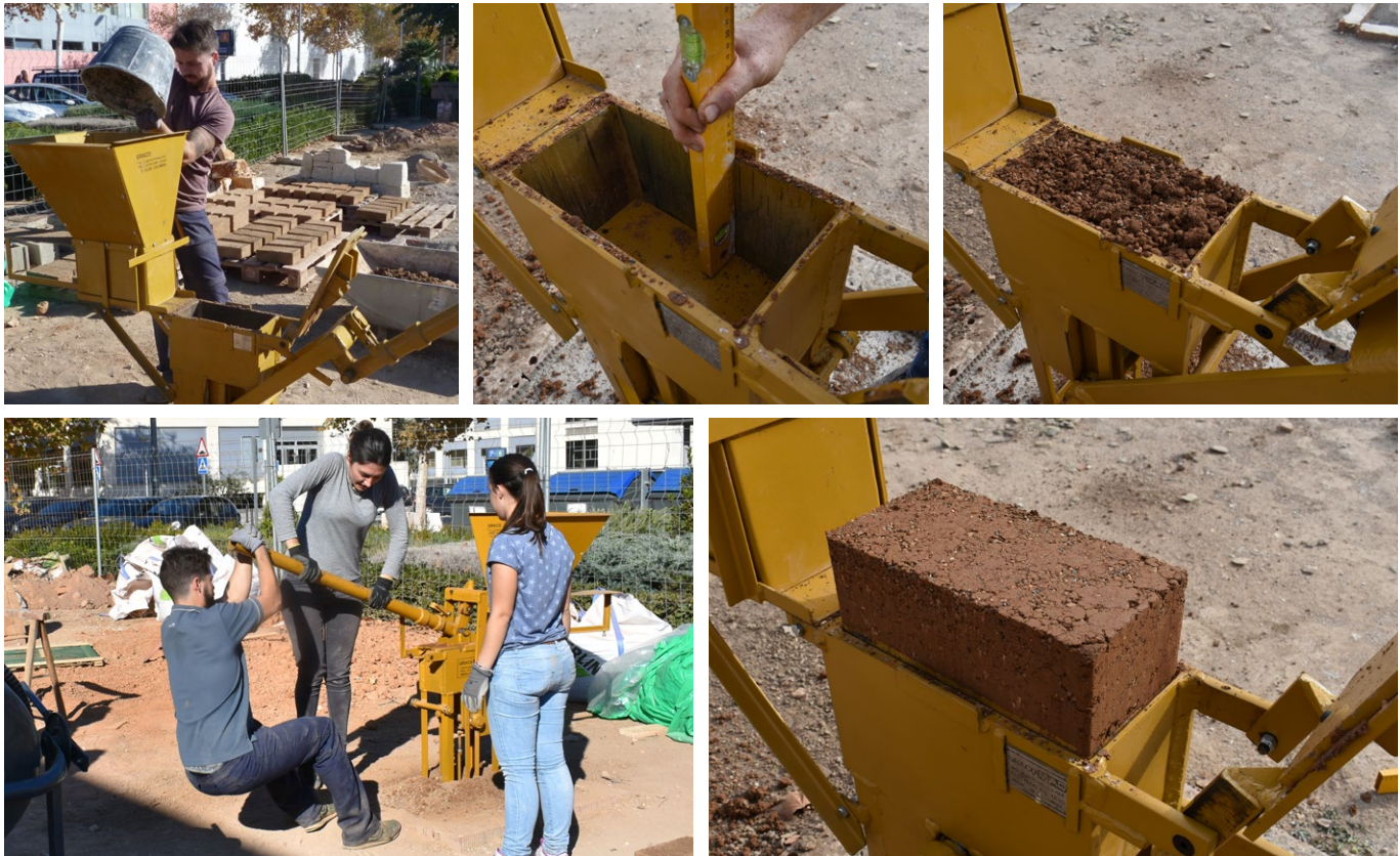
Production du BTC dans le cadre du projet ConBurkina à l'Universitat Politècnica de València.
