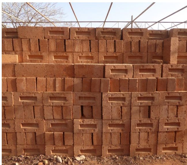
Blocs de terre comprimée utilisés dans la construction de l'Opera Village conçu par Francis Kéré.
