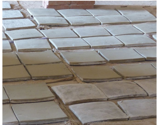
Dalles en terre argileuse disposées pour être aérées avant d'être placées dans le four à céramique.
