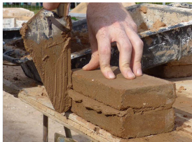
Expérimentation de mortiers en terre dans les installations de l'UPV.
