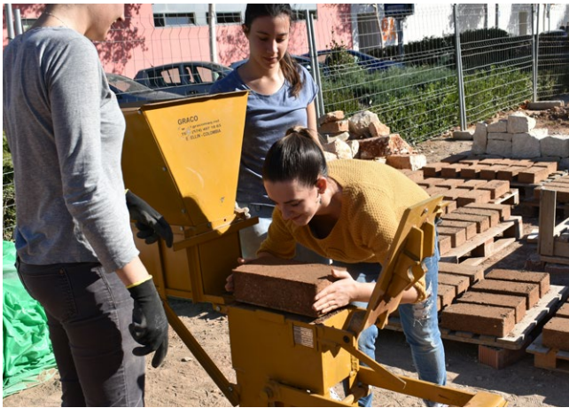
Blocadora manual para la producción de BTC. Universitat Politècnica de València.
