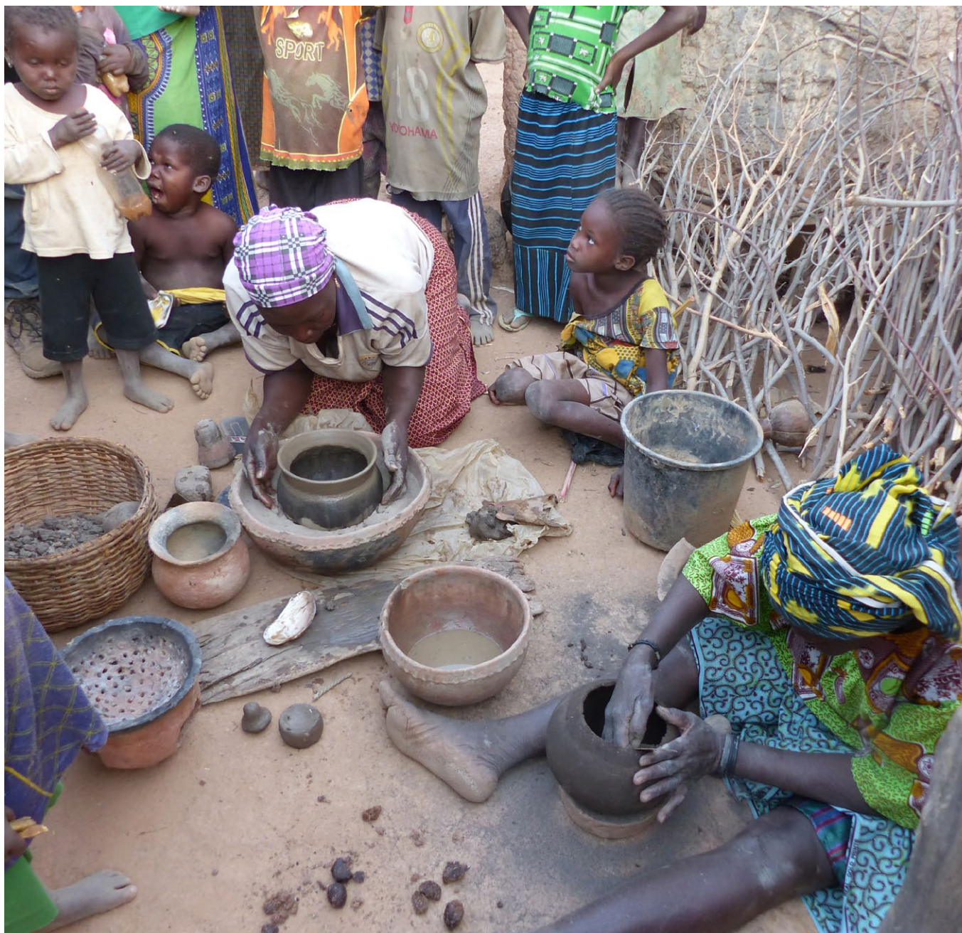
Proceso de conformación de recipientes cerámicos sin torno.
