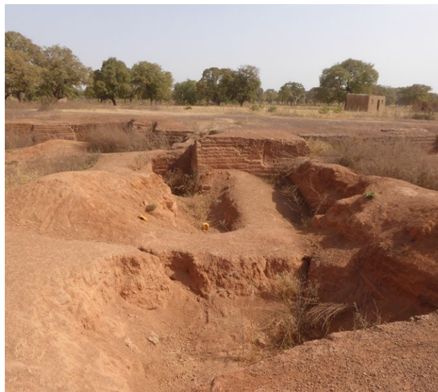
Cantera de extracción de bloques tallados de laterita o BTL.
