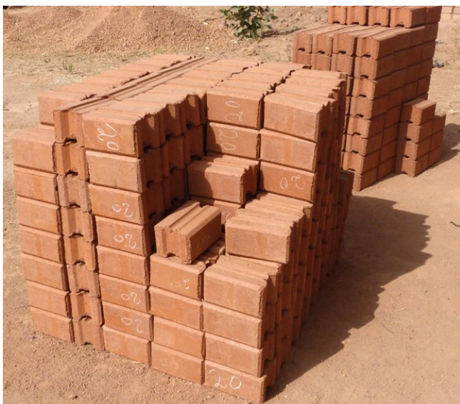
Bloques de BTC acopiados.
