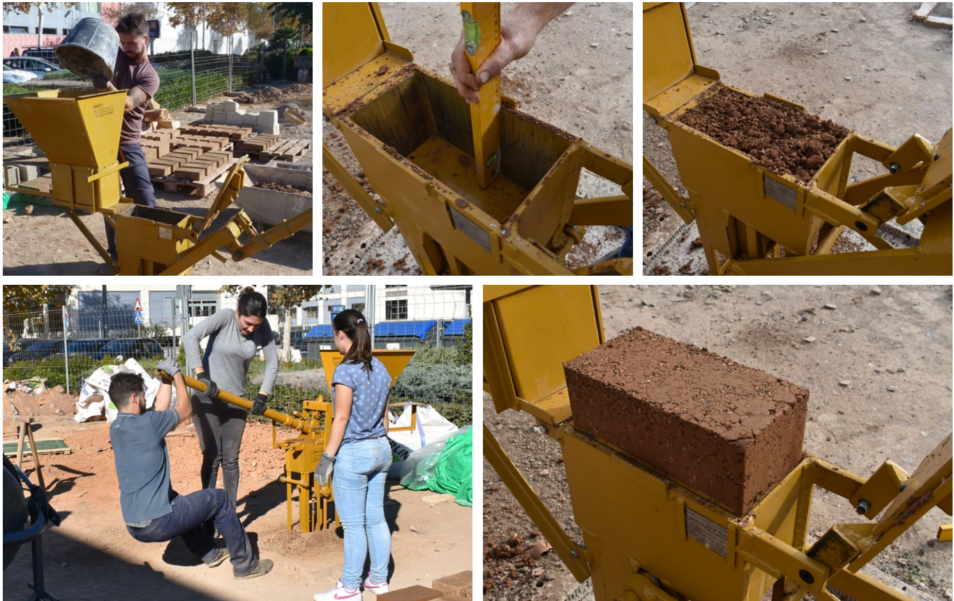
Producción de BTC en la Universitat Politècnica de València como parte del proyecto ConBurkina.
