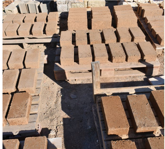
BTCs fabricados en la Universitat Politècnica de València.
