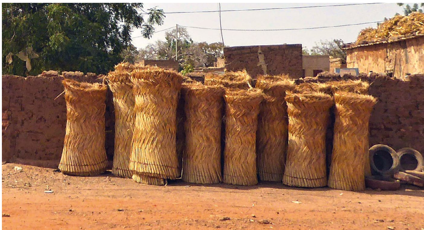
Esteras tejidas de paja preparadas para aplicar en la construcción.
