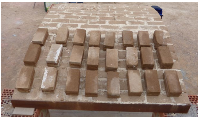
Ensayos de adherencia realizados con diferentes dosificaciones de mortero para determinar las proporciones idóneas para la construcción de la bóveda.
