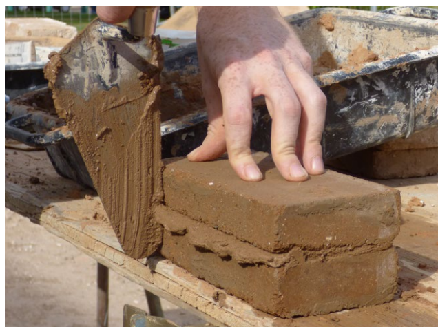
Experimentación con morteros de tierra en las instalaciones de la UPV.
