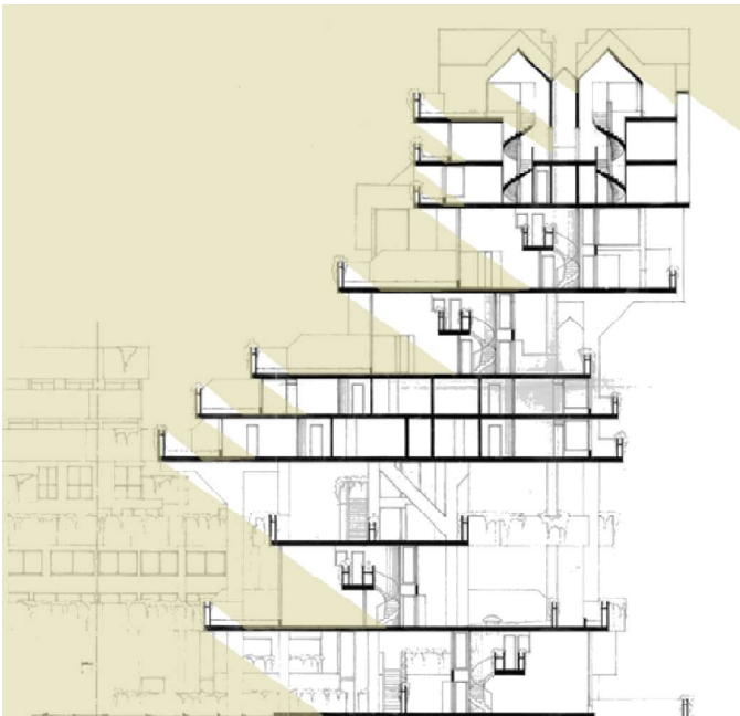
Figura 104: Diagrama del soleamiento en verano sobre sección del proyecto.
