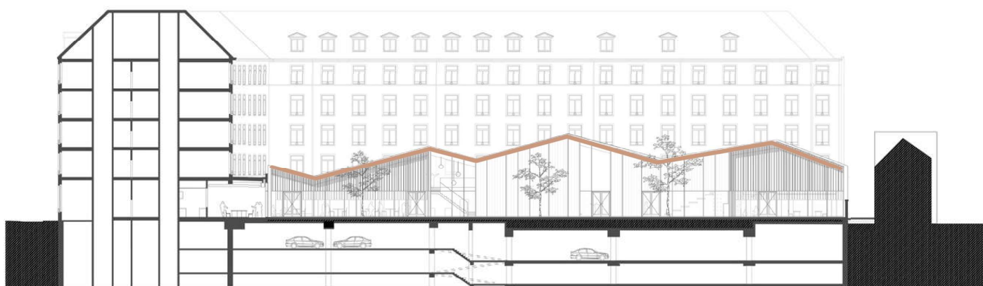
Figura 172: Diagrama de la morfología de cubierta sobre el alzado oeste del proyecto .
