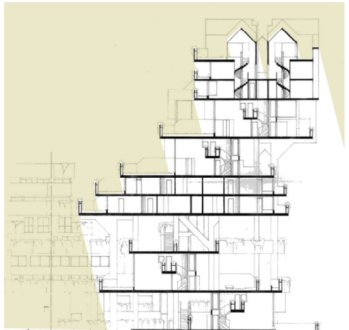
Figura 105: Diagrama del soleamiento en invierno sobre sección del proyecto.
