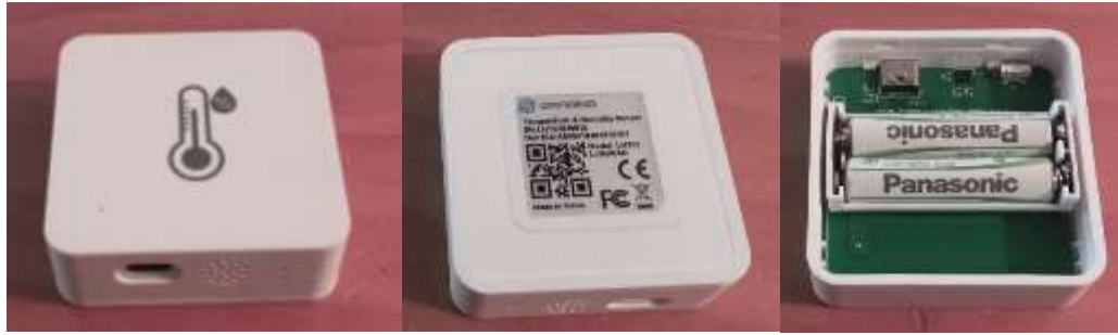
Figura 42. Sensor de temperatura y humedad de Dragino. A la derecha se muestra la parte frontal. En el centro se muestra la parte de abajo, donde está la información del dispositivo. Y a la izquierda el interior del dispositivo.
