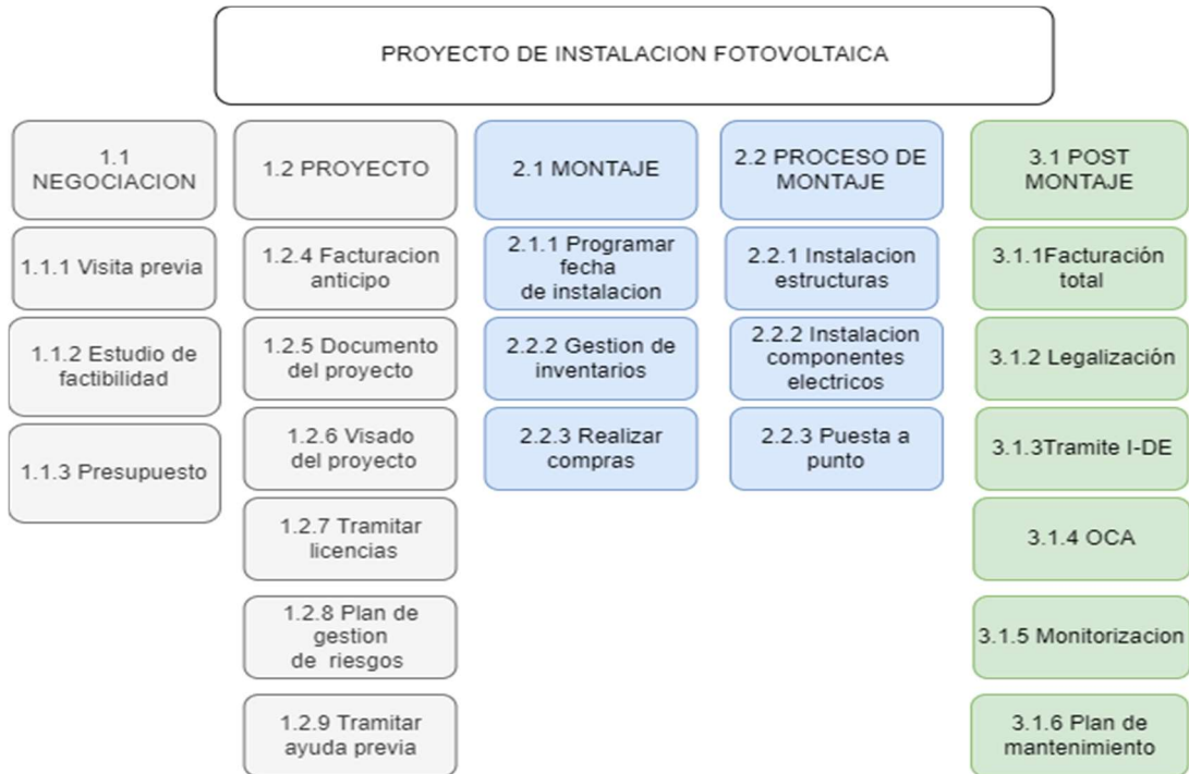
Figura 14. EDT del trabajo de los proyectos de instalación a naves industriales Fuente: Elaboración propia.
