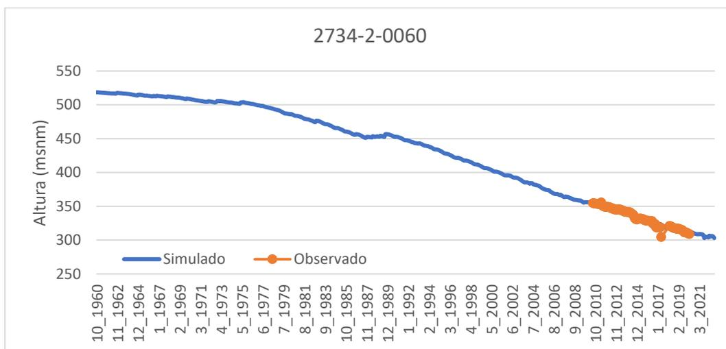
Figura 43. Calibración del piezómetro 2734-2-0060.
