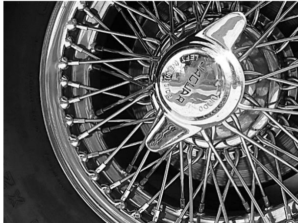
Figura 1.6: Detalle de una rueda metálica de radios.
