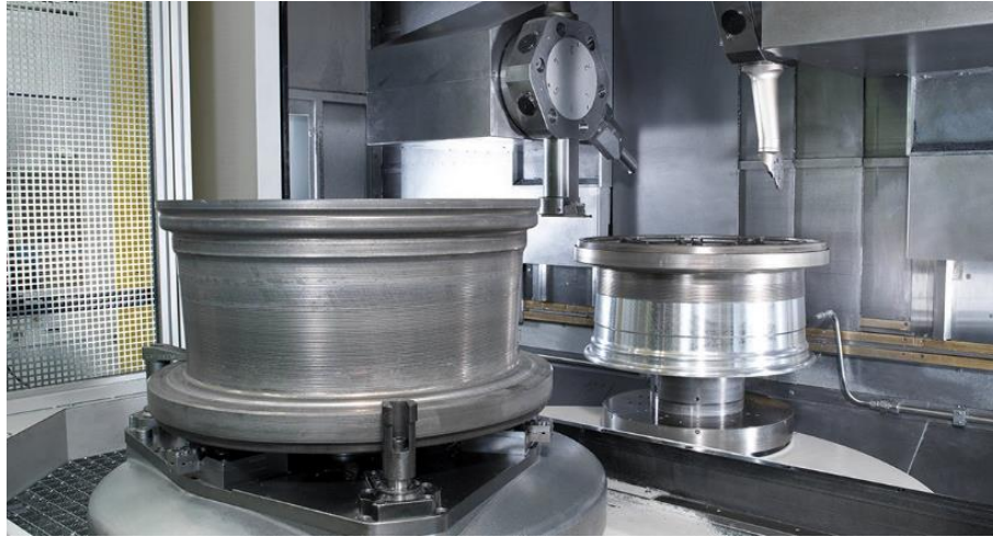
Figura 1.11: Llantas en bruto dentro de un centro de mecanizado.
