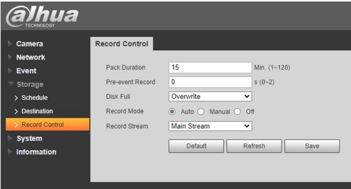
Figura 40. Pantalla web server de la cámara. Storage>Record Control
