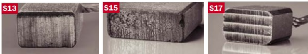
Figura 54. S13 (quemadura de Borde), S15 (superficie erosionada) y S17 (segmentos quemados en cara deslizante) [Helwing 2 2013].
