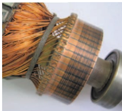
Figura 18.a) (izq.), Sección de un conmutador de delgas [Dominguez 2008], (b) (der.) Partes de una delga [Pozueta 2010], (c) Colector [Martín 2012].
