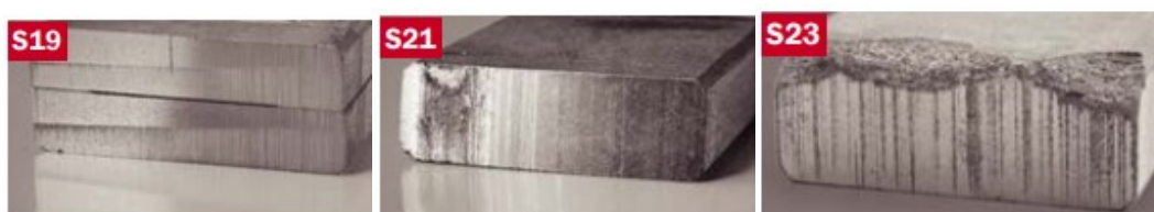
Figura 55. S19 (doble cara de deslizamiento, escobilla Twin), S21 (Segregaciones de cobre) y S23 (Bordes quebrados) [Helwing 2 2013].
