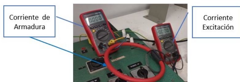
Figura 79. Comprobación de la medida RMS de Corriente de Armadura y de Excitación para cada Prueba usando polímetros comerciales.
