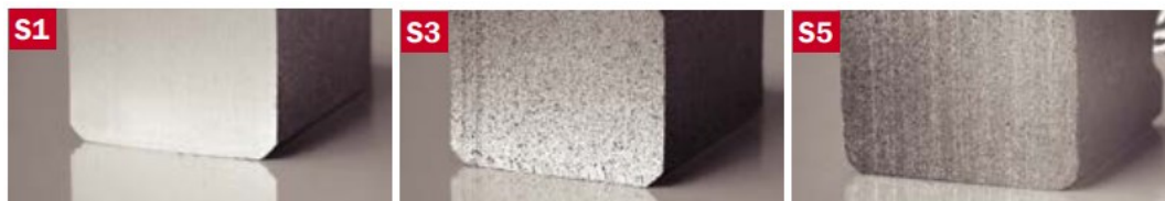
Figura 52. Desgaste normal , S1 (aparición fina densa), S3 (aparición porosa) y S5 (presencia de polvo circundante en la atmósfera de operación) [Helwig 2 2013].
