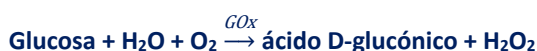
Reacción I.12. Descomposición enzimática de glucosa: mecanismo de propulsión de los nano- y micromotores compuestos por GOx.
