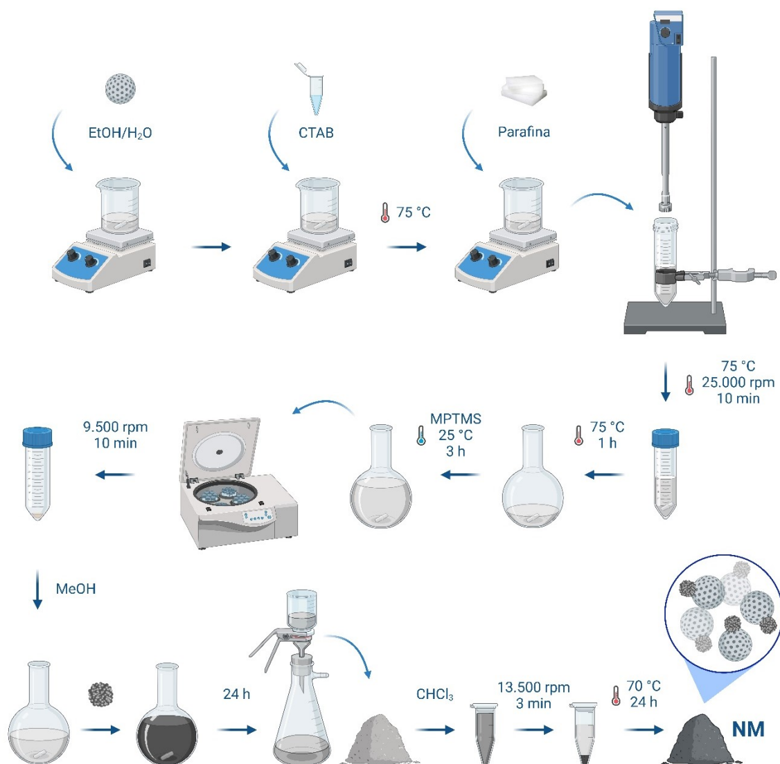
Figura III.6. Representación esquemática del procedimiento seguido para la síntesis de NM.
