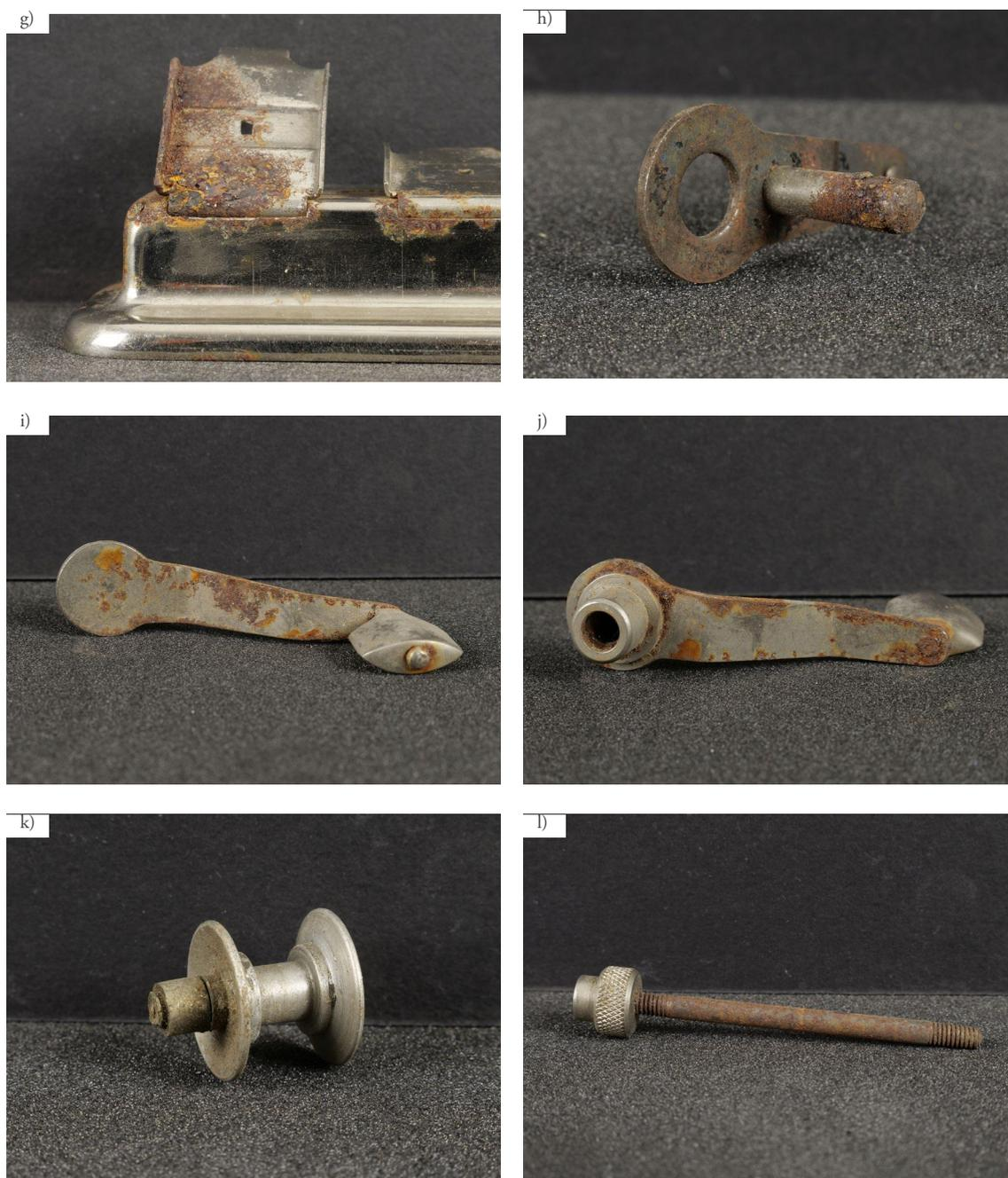
FIG. 60. Fotografías iniciales complementos *Pathé-Baby*. g) Detalle bisagra *presse à collar* corroída; h) Manivela de sustitución 1; i) Manivela de sustitución accionamiento de mecanismo; j) Rodillo de sustitución *Super Pathé-Baby*; k) Tornillo de sustitución para la base
