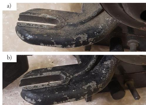
FIG. 41. Limpieza de la película pictórica mediante AE3 en el motor del proyector. a) Antes; b) Después
