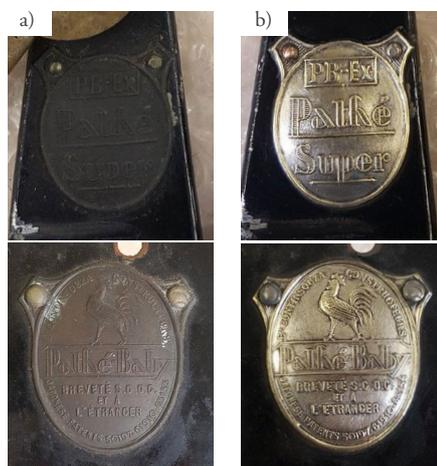
FIG. 46. Limpieza de placas identificativas con lana de acero n°0000. a) Antes; b) Después
