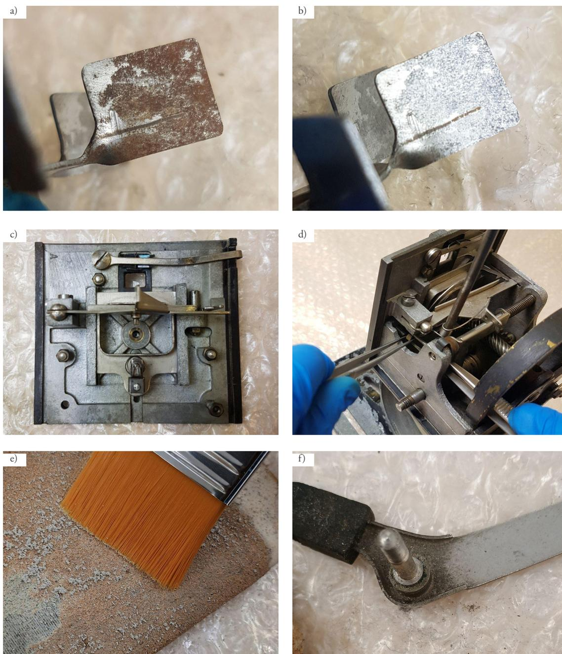
FIG. 62. Intervención *Pathé-Baby*. a) Hélice del motor oxidada; b) Hélice del motor tras la limpieza con lana de acero; c) Parte delantera interior del mecanismo de proyección tras la limpieza; d) Montaje de la caja del mecanismo de proyección tras su limpieza íntegra; e) Aplicación de polvo de goma para la limpieza de la resistencia; f) Diferencia de limpieza en palanca de regulación de intensidad de la resistencia
