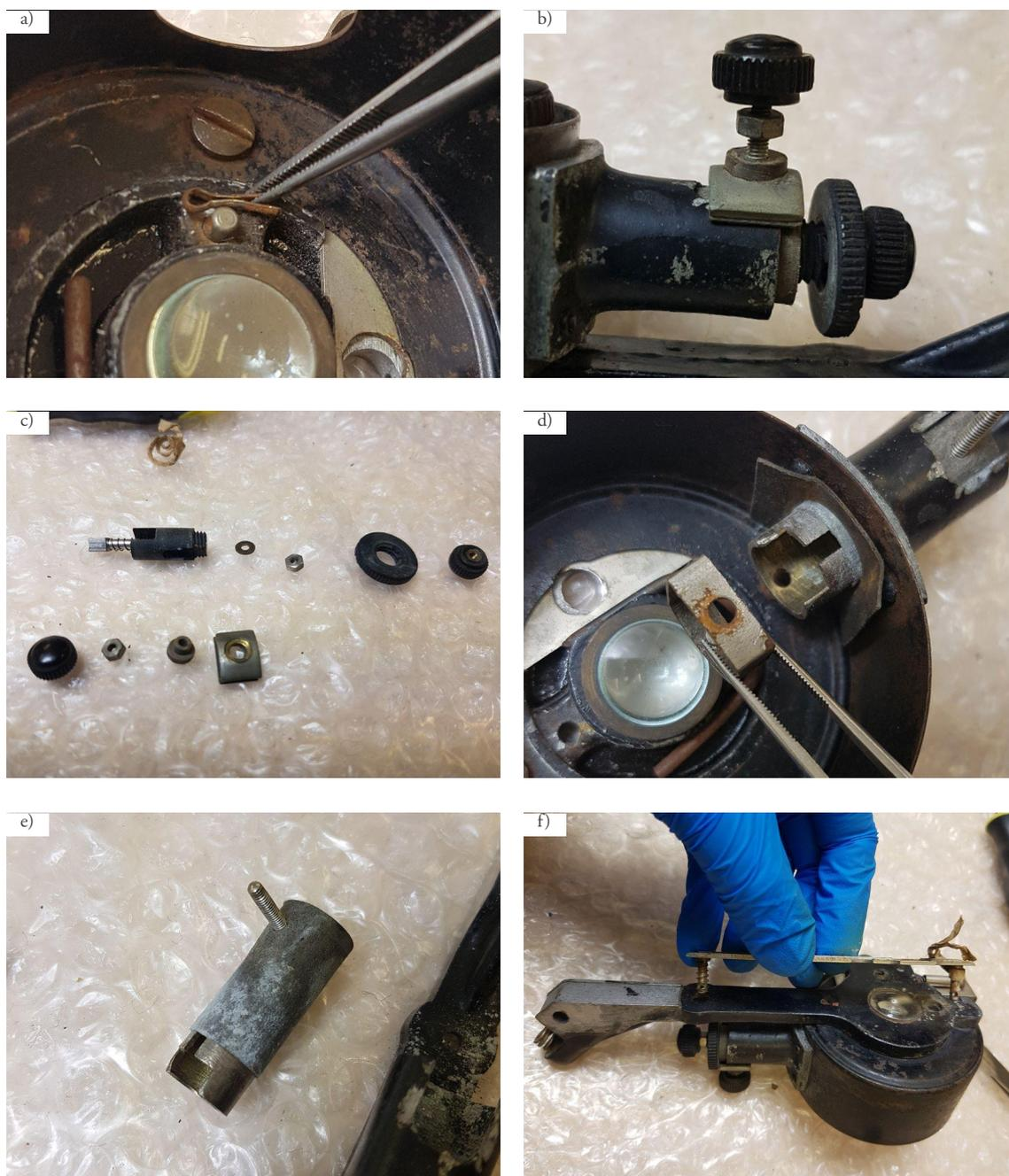
**FIG. 63.** Desmontaje interior de la linterna tras la retirada de la bombilla. a) Retirada de pasadores de seguridad; b) Detalle de la colocación de los elementos; c) Desmontaje de los diferentes elementos; d) Retirada de pieza metálica para su limpieza; e) Pieza metálica interna recubierta de placa de cartón para su aislamiento; f) Muestra de diferencia entre el muelle original y la sustitución realizada por los anteriores dueños con una tira de papel
