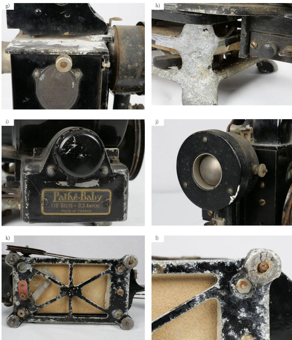
FIG. 59. Fotografías de detalle *Pathé-Baby* A. g) Levantamiento de película pictórica en caja del mecanismo de proyección; h) Levantamiento de película pictórica en base, acumulaciones de polvo y corrosiones; i) Características motor; j) Tapa de la linterna; k) Zona inferior de la base; l) Pie de goma desgastado y corroído;
