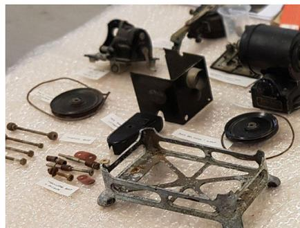
FIG. 32. Desmontaje del *Pathé-Baby* con su correspondiente etiquetado
