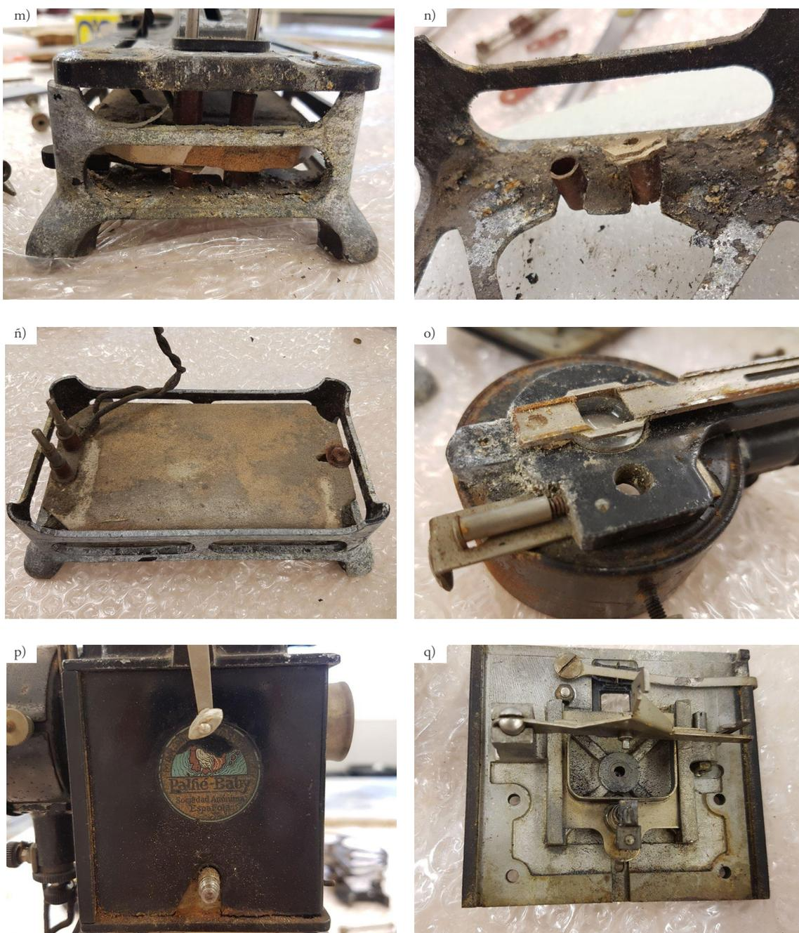
FIG. 59. Fotografías de detalle *Pathé-Baby* A. m) Acumulación de polvo en la base de la resistencia; n) Aislamiento tornillería resistencia degradado y modificado; ñ) Resistencia, parte superior; o) Linterna parte trasera; p) Pegatina *Pathé-Baby*; q) Parte delantera interior del mecanismo de proyección
