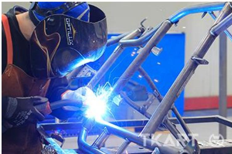
*Ilustración 18: Soldadura de tubos de acero*
