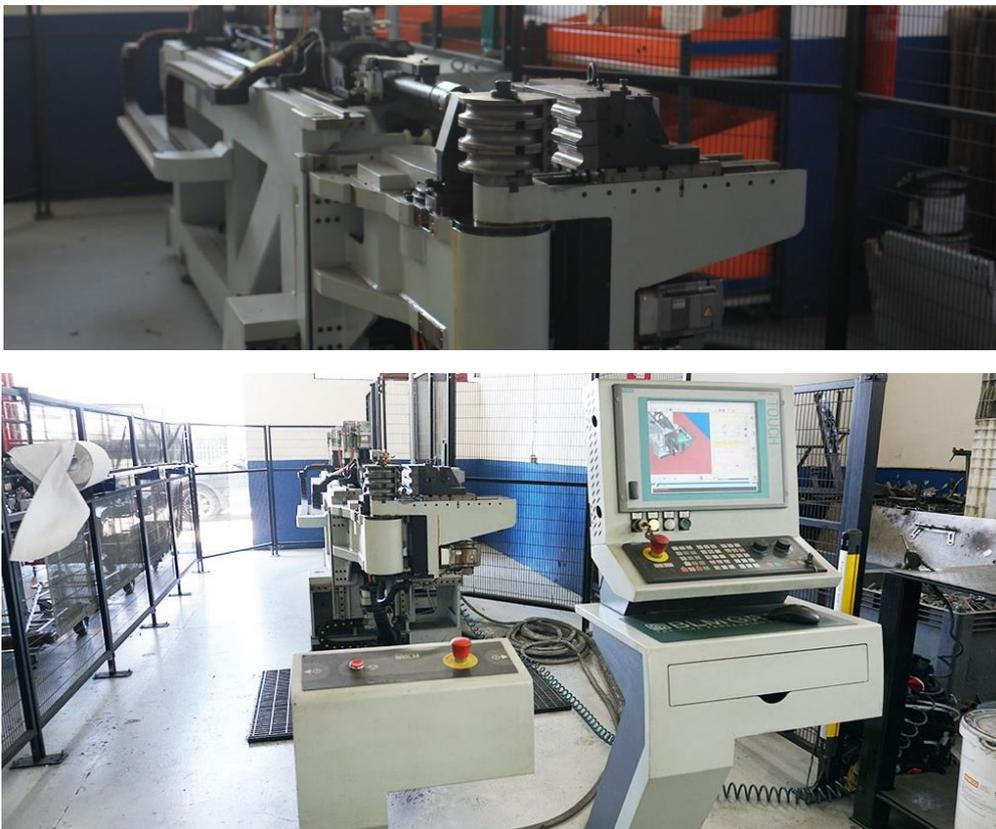
*Ilustración 51: Máquina dobladora de tubos*
