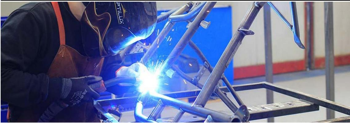
*Ilustración 52: Soldadura de los tubos*
