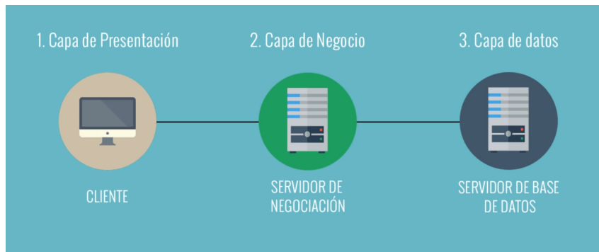
Figura 6.1: Arquitectura en 3 capas o niveles
