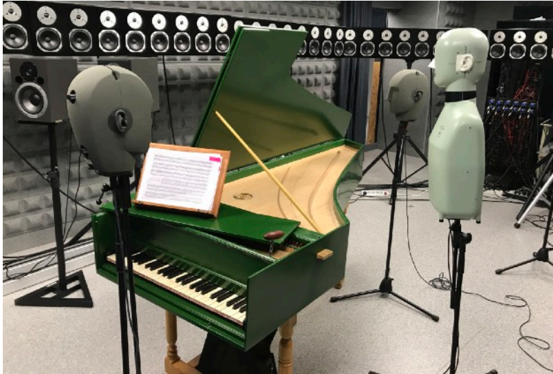
[IMAGEN 32] Fotografía de la colocación Curve A . N7 al teclado. B al inicio de la curva del clavecín y N5 al final de la curva. Todos "miran" hacia dentro del instrumento.
