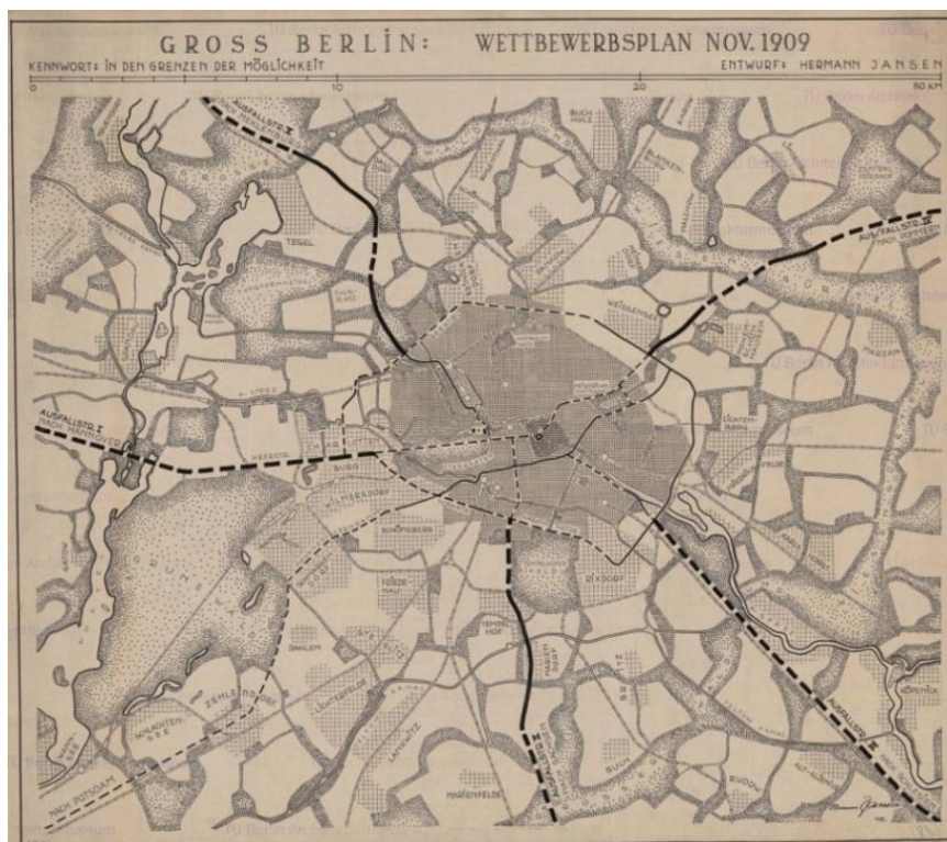
Figura 4. Gross-Berlin. Estructura viaria radial para la ampliación de la ciudad
