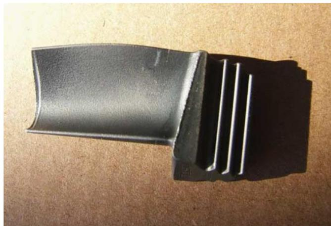
Figura 16. Agrietamiento por fatiga en el borde de ataque de un álabe a la derecha de la marca de lápiz. Fuente: *Common failures on gas turbine blades* (Carter, 2004) [5]
