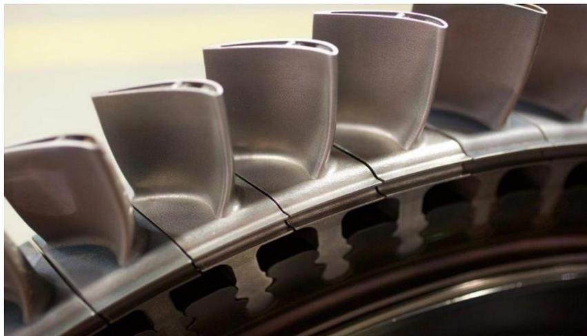
Figura 12. Corona de álabes de un rotor. Fuente: Nova Àgora Grup, S.L.
