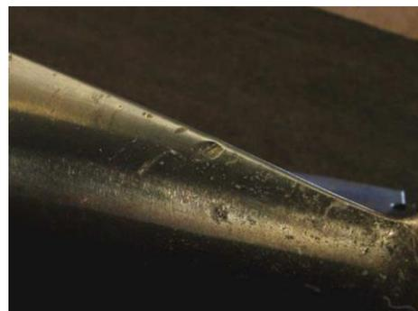
Figura 14. Daño mecánico en el borde de ataque de un álabe de compresor. Fuente: *Common failures in gas turbine blades* (Carter, 2004) [5]
