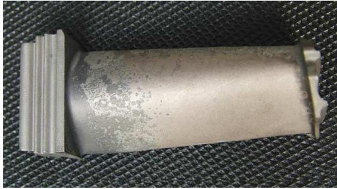
Figura 17. Sulfuración en un álabe de turbina. Fuente: *Common failures in gas turbine blades* (Carter, 2004) [5]
