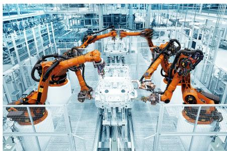
(a) Célula robotizada de Robots industriales articulados KUKA
