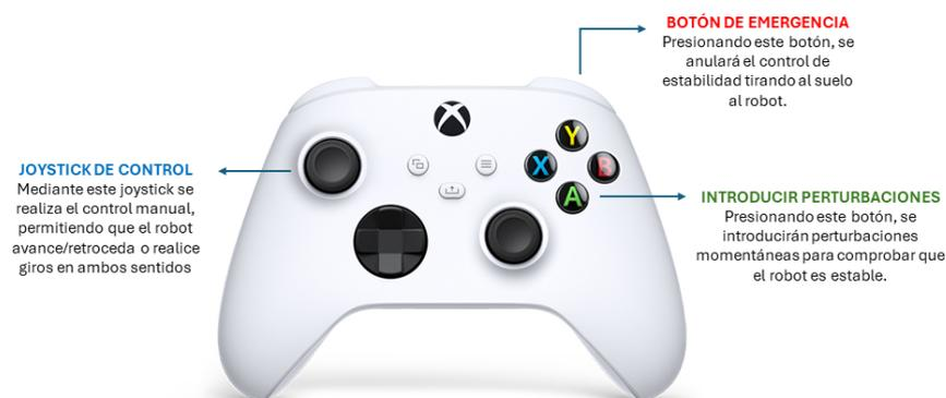
Figura 1.31: Funciones del mando para el control manual.
