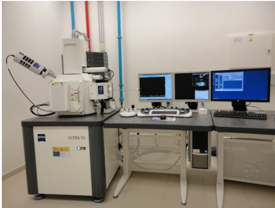
Figura III.3.9. Imagen del Microscopio Electrónico de Barrido con Emisión de Campo (FESEM) ZEISS ULTRA.
