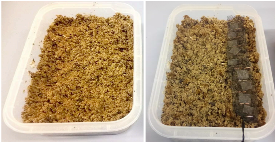
Figura III.3.15. Imagen del sustrato preparado según normativa (izquierda) y reactor con muestras preparadas para su enterramiento (derecha).
