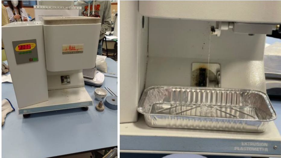
Figura III.3.11. Imagen del equipo de medición del índice de fluidez (izquierda) y detalle de la boquilla de salida del material extruido (derecha).
